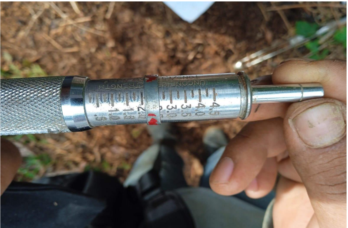
Figura 12. Medición de la resistencia del suelo con el instrumento denominado penetrómetro.
