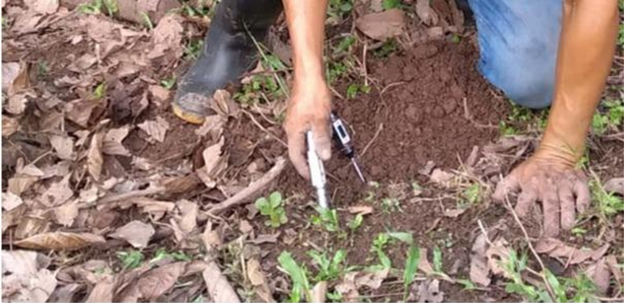
Figura 11. Medición de temperatura, resistencia de penetración al suelo y densidad aparente.
