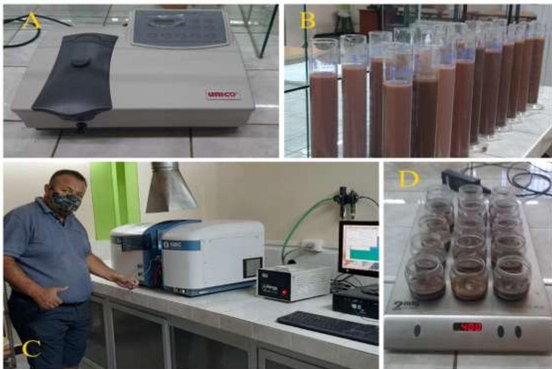
Figura 36. A: Espectrofotómetro Uv visible para fósforo: B: Determinación de textura C: Espectrofotómetro de absorción atómica determinación de (K, Ca, Mg y Na); D: Agitador por inducción de muestras.
