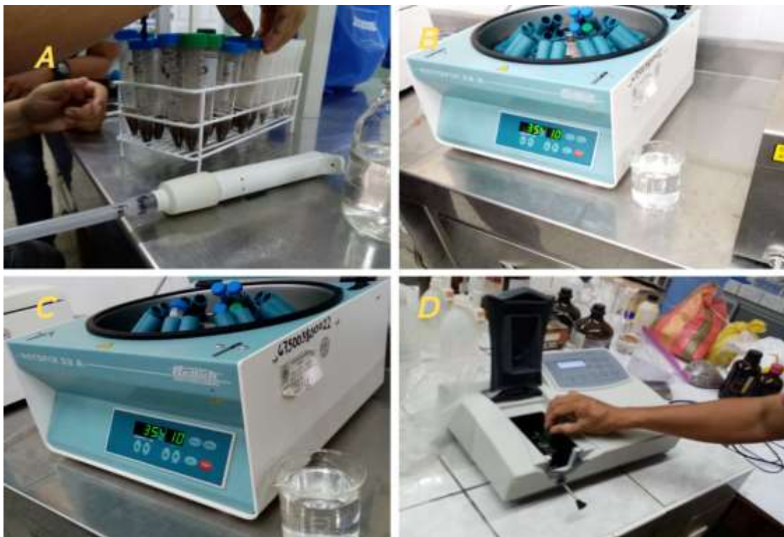
Figura 32. Determinación de ureasa A: Tubos con sedimento B y C: Centrifugación D: Lectura espectrofotómetro
