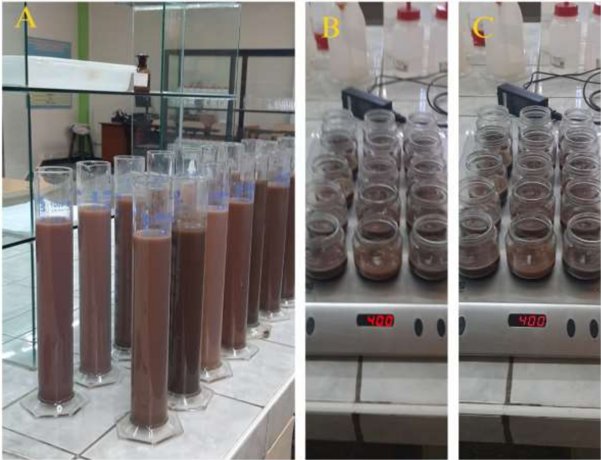
Figura 39. A: Determinación de textura por Bouyoucos; B y C: Agitadores por inducción magnética.
