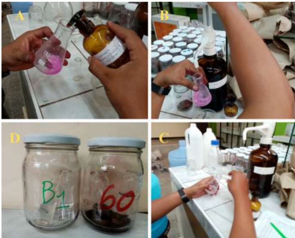
Figura 30. Determinación de respiración basal A, B y C: Titulación; D: Captura de CO 2
