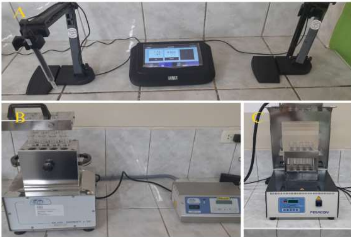
Figura 35. A: Determinación de pH y conductividad eléctrica; B y D: Digestores de muestras.
