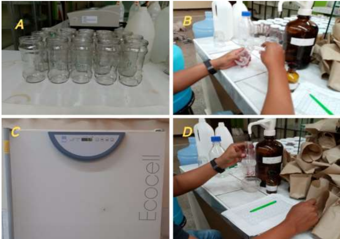
Figura 31. Determinación de biomasa microbiana A: Frascos para secado e incubado C: Estufa de secado B y D: Titulación
