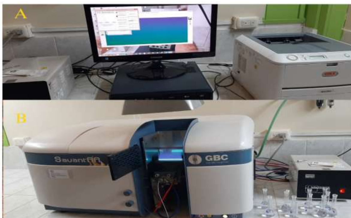
Figura 38. B: Espectrofotómetro de absorción atómica para determinación de metales (K, Ca, Mg y Na); A: Software del equipo de absorción atómica
