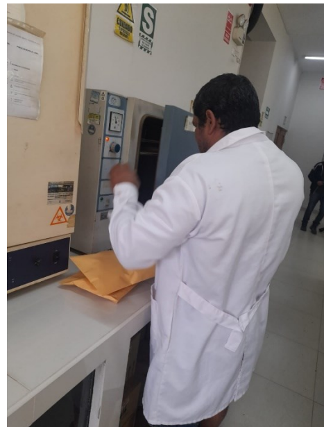
Figura 7 y 8. Puesta las muestras en la estufa para determinar el peso seco
