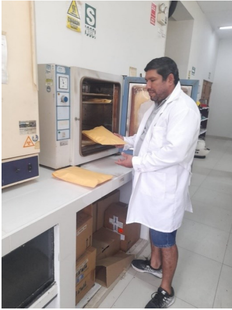
Figura 7 y 8. Puesta las muestras en la estufa para determinar el peso seco
