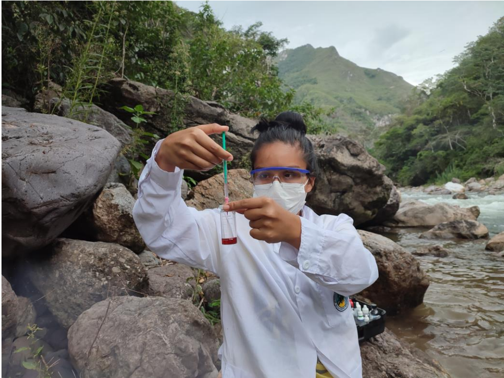
Figura 42. Obtención de la alcalinidad \text{CaCO}_3 (se titula con el reactivo de titulación de alcalinidad).
