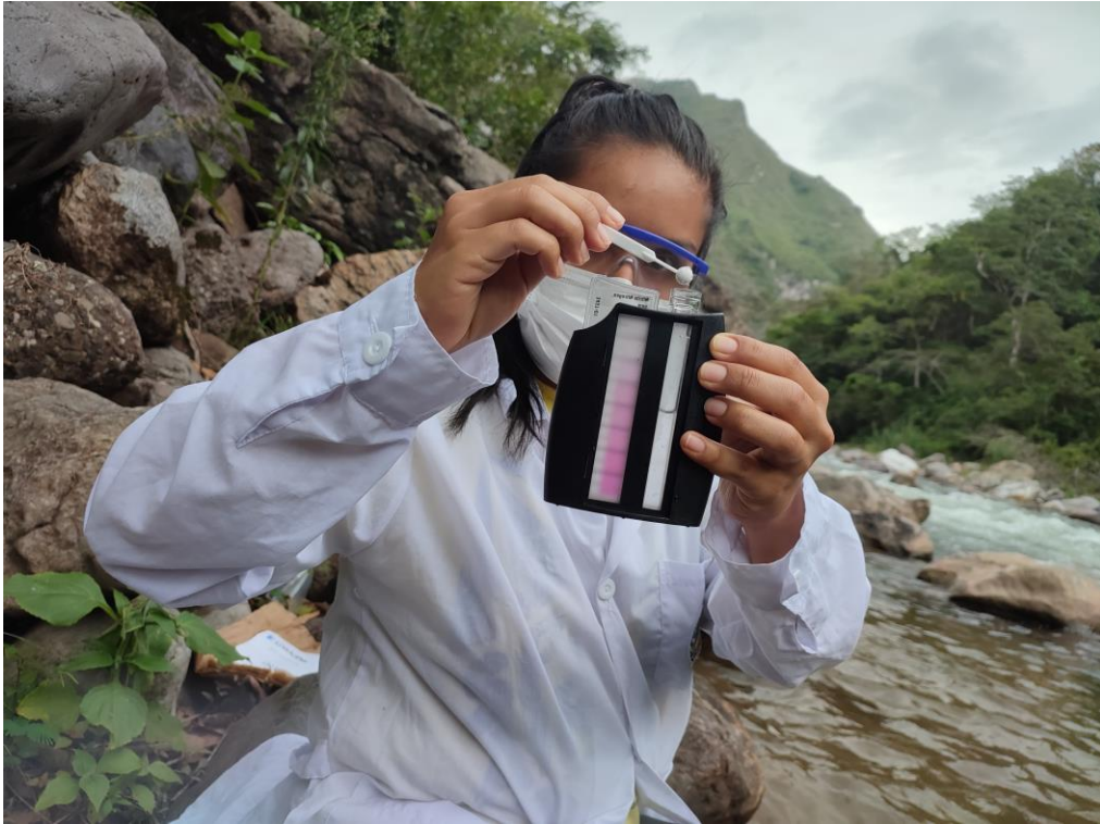
Figura 44. Medición de nitrógeno nitrito ( \text{NO}_2\text{-N} ).
