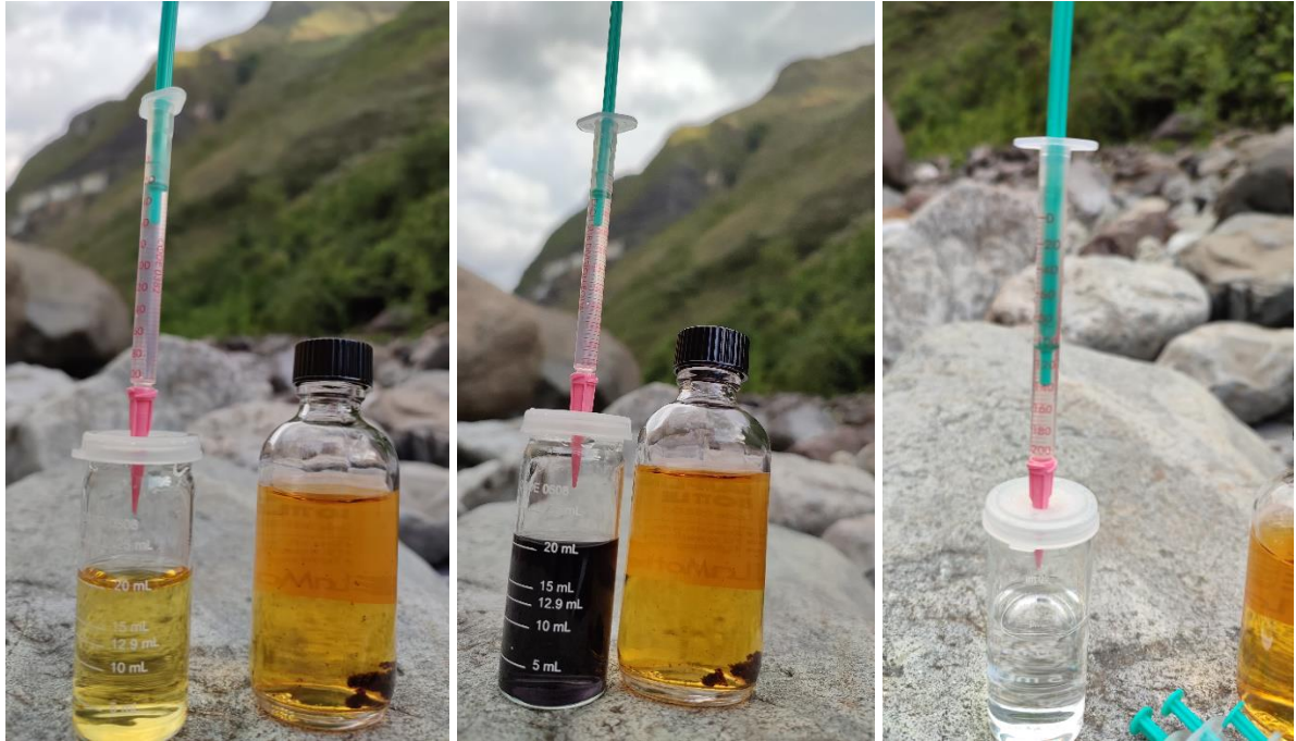
Figura 48. Obtención de ppm de oxígeno disuelto (izquierda; el preservado de la muestra se le agrega tiosulfato de sodio hasta obtener un amarillo tenue, medio; se agrega 8 gotas de solución indicadora de almidón volviéndose de color azul la muestra y derecha; titular la muestra hasta que se vuelva incolora el agua).
