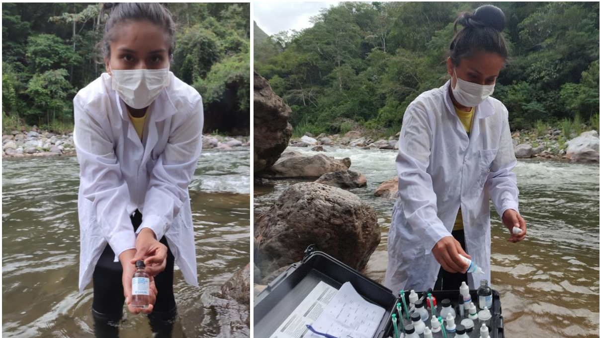
Figura 47. Obtención de ppm de oxígeno disuelto (izquierda; recolección de la muestra y derecha-agregando; los reactivos para la preservación de la muestra).
