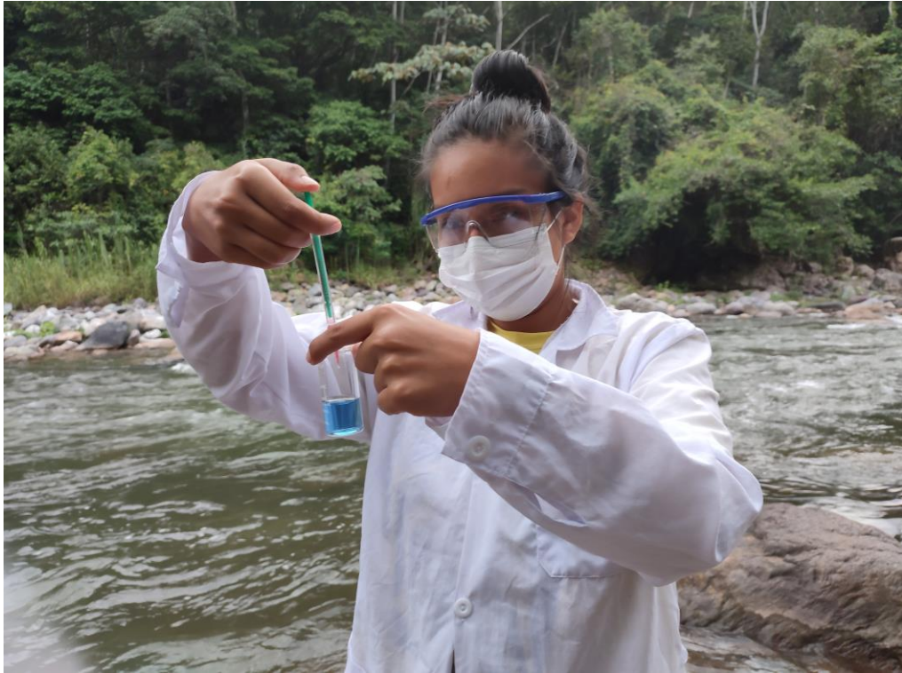
Figura 46. Obtención de ppm dureza total ( \text{CaCO}_3 ) (titulando con el reactivo de dureza #7 hasta obtener un azul claro).
