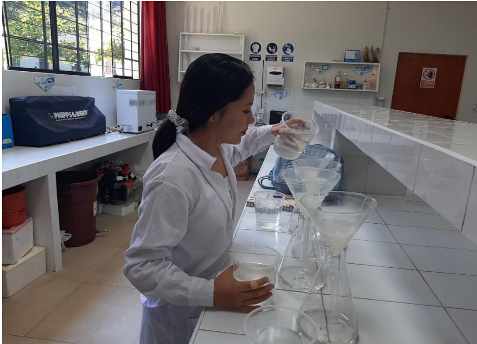
Figura 38. Realizando el proceso de filtración
