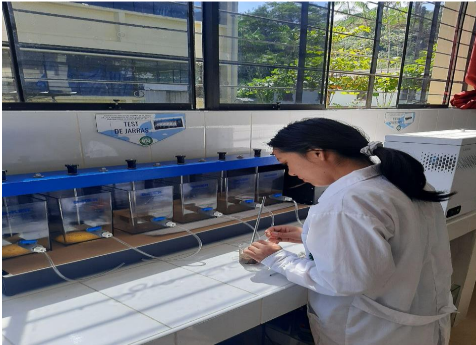
Figura 32. Aplicando dosis de floculante en el test de jarras.
