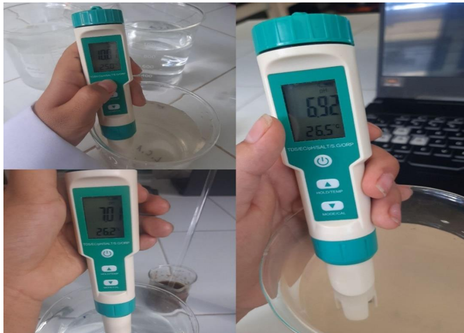
Figura 31. Calibración de pH con el coagulante.
