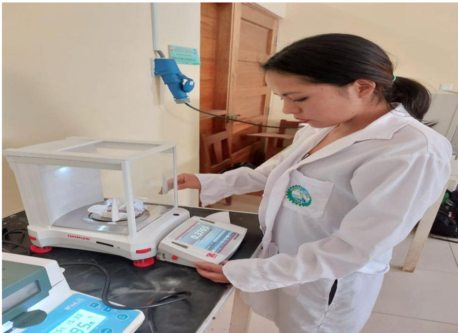
Figura 45. Pesado del papel fitro despues de la filtración.
