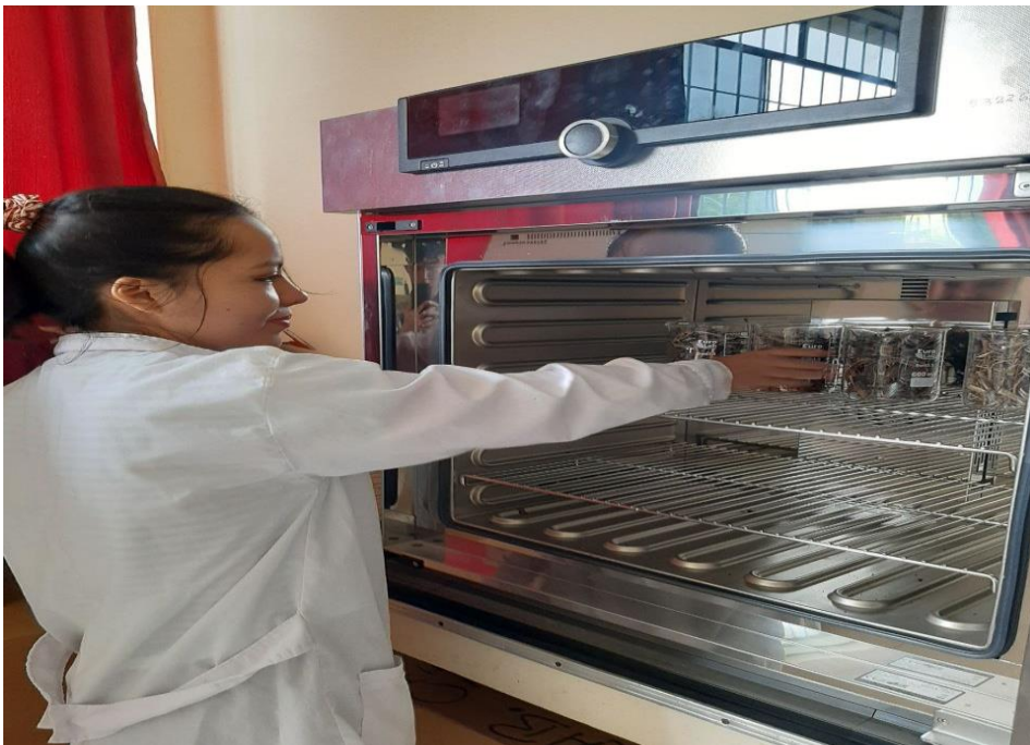
Figura 25. Secado de la corteza en el horno eléctrico.
