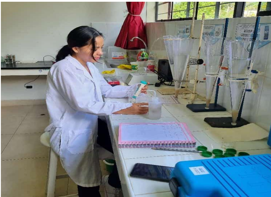
Figura 37. Medida del pH después del proceso de coagulación – floculación.
