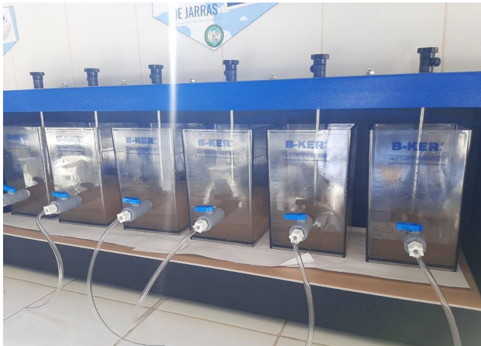
Figura 33. Colocación de 1L de agua en el test de jarras.
