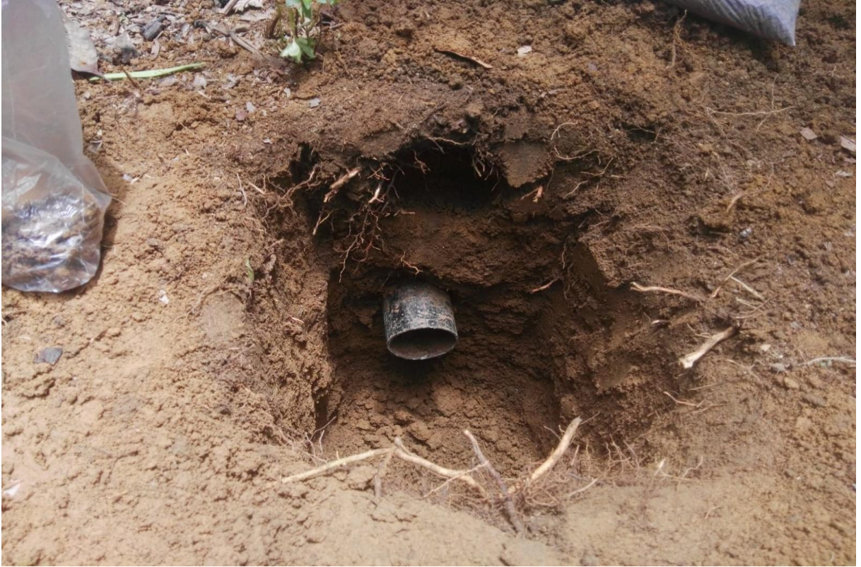
Figura 21. Extracción de cilindro muestreador de densidad aparente en la parcela de sistema con macorilla.
