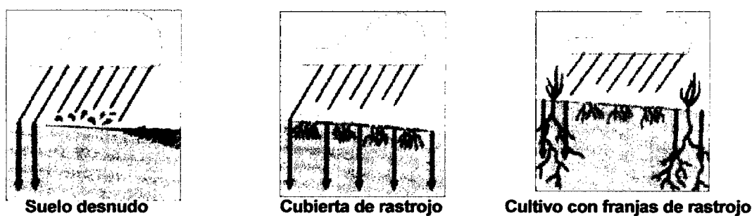
Figura 6. Acción de la cobertura, sobre el impacto de las gotas de lluvia.
