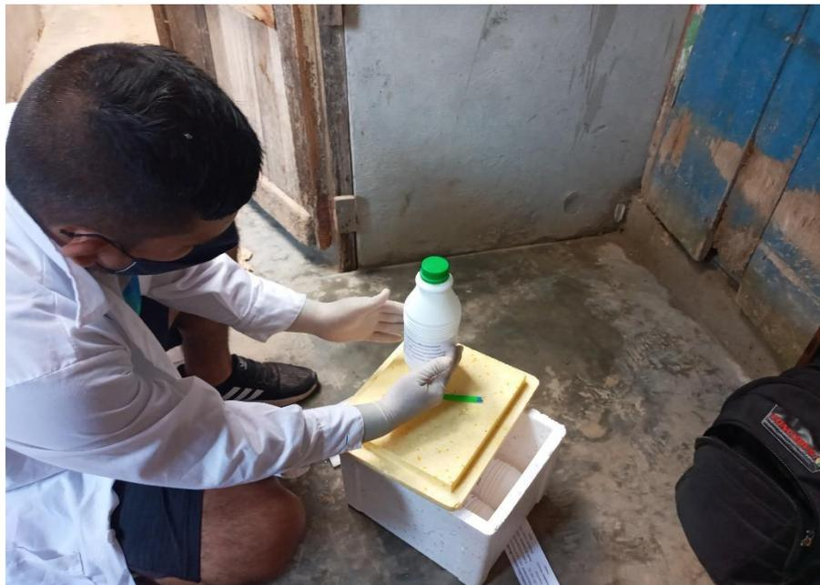
**Figura 39.** Rotulado y etiquetado de las muestras de agua en el punto de muestreo – conexiones Domiciliarias 1.
