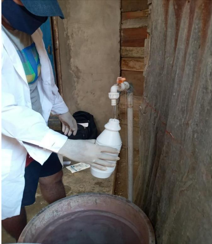
**Figura 38.** Toma de muestra de agua en el punto de muestreo – conexiones domiciliarias 1.
