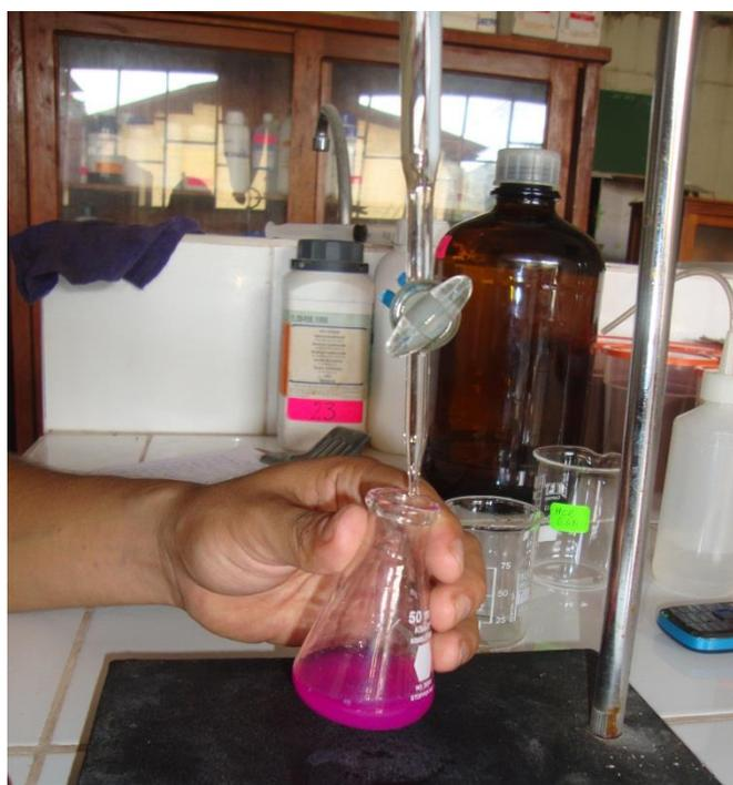
Figura 26. Realizando la medición de CO<sub>2</sub> respirado por el suelo.
