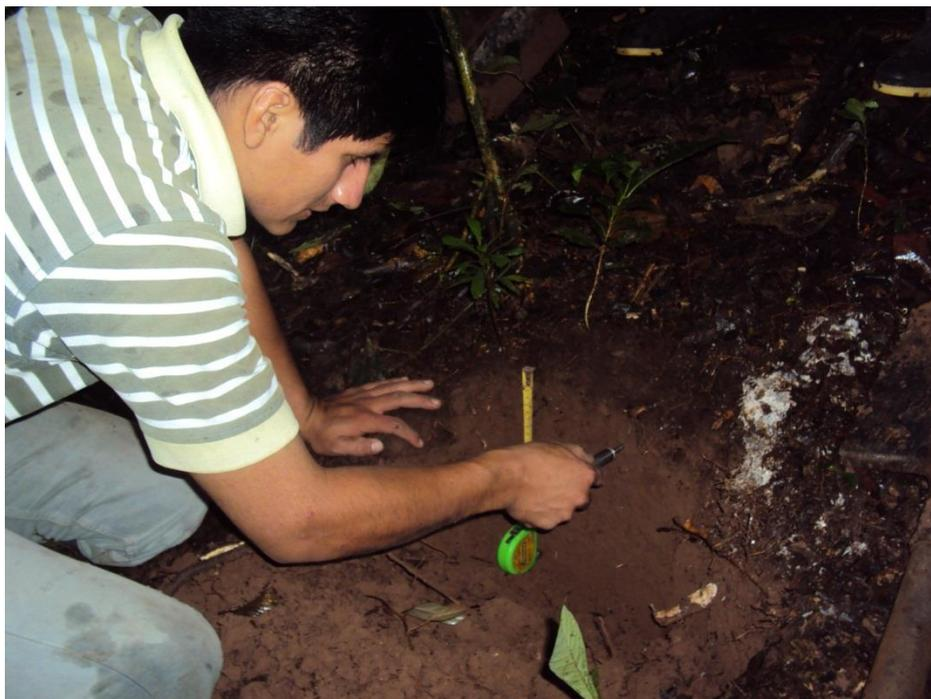
Figura 21. Medición de la resistencia del suelo a la penetración.
