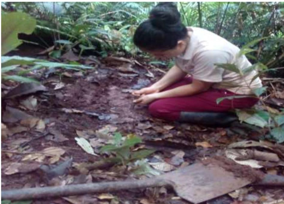
Figura 10. Medida de resistencia a la penetración del suelo.
