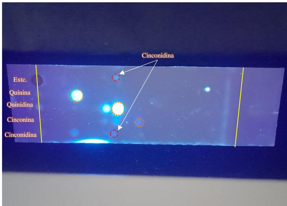
**Figura 7.** Placa Cromatográfica del extracto de corteza y los cuatro patrones.
