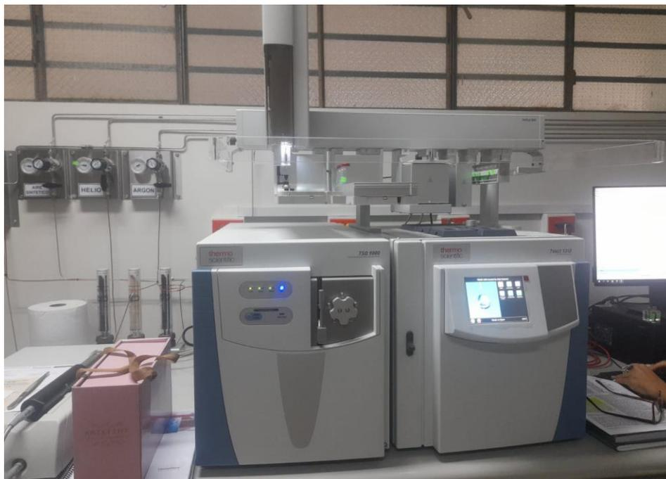
**Figura 32.** Cromatógrafo de gases acoplado a Espectrometría de masas GC/MS.
