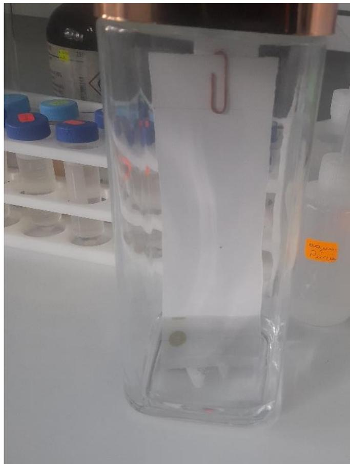
**Figura 26.** Placa cromatográfica dentro de la cámara corrido.
