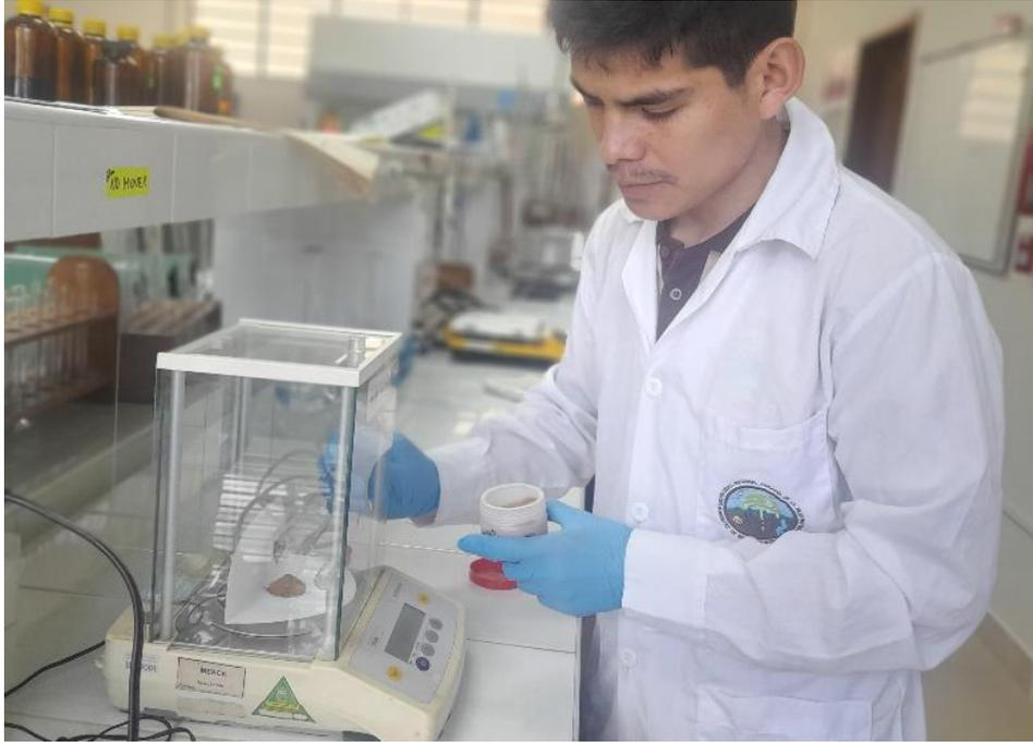
**Figura 27.** Pesado de la muestra de corteza para la extracción en el equipo Soxhlet.
