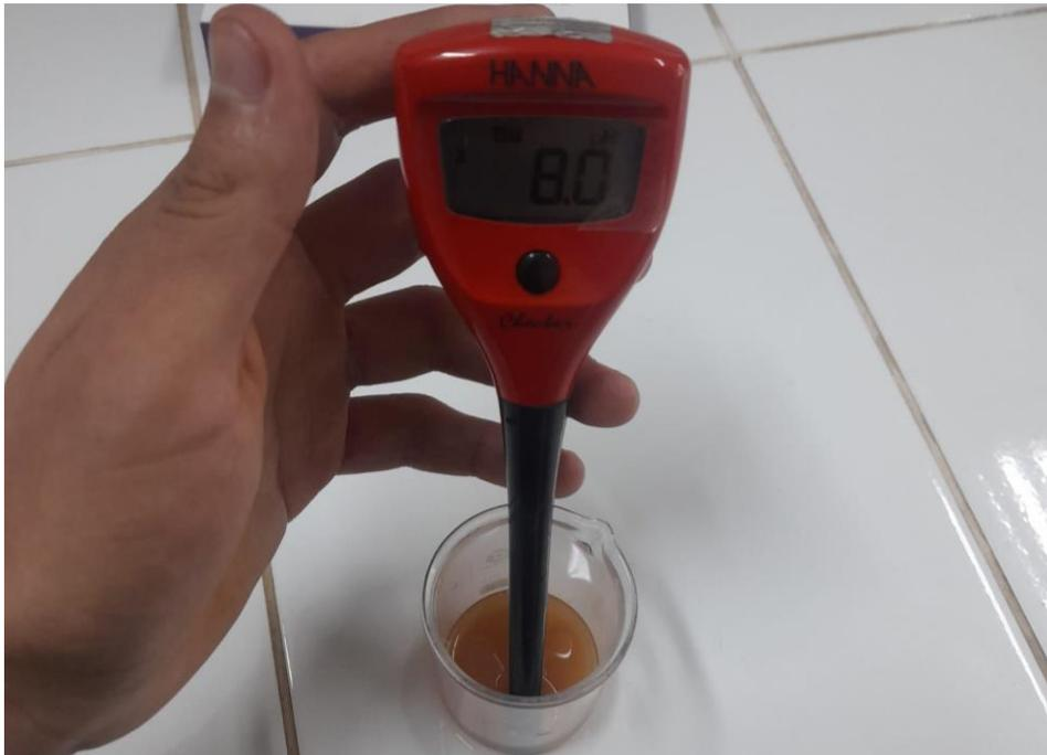
**Figura 30.** Medición del pH luego de haber agregado hidróxido de amonio a la solución ácida.
