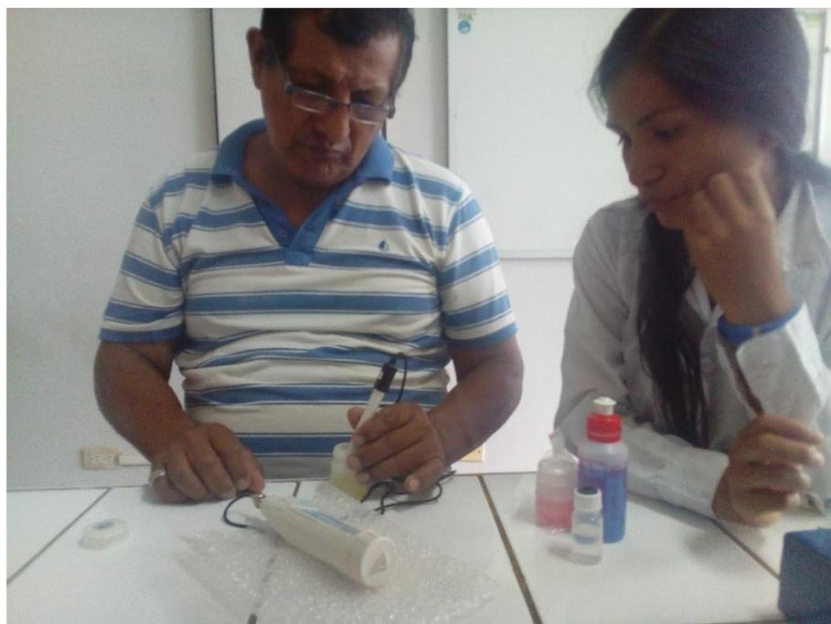
Figura 45. Calibración de pHímetro.
