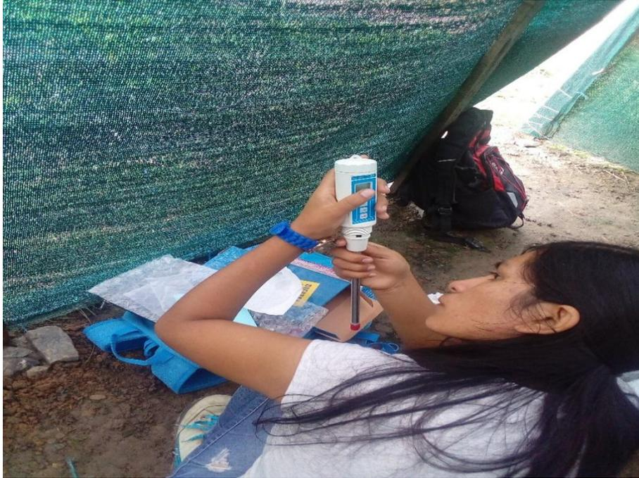
Figura 38. Calibracion del Higrómetro digital.
