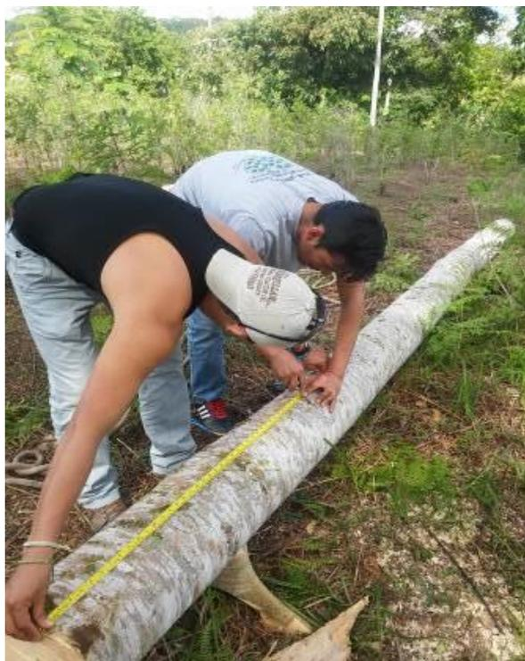
Figura 14. Medición a cada metro para coeficiente de forma.
