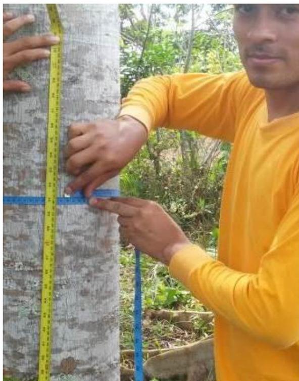
Figura 13. D.a.p. a 1.30 m de la base del árbol para distribución diamétrica.
