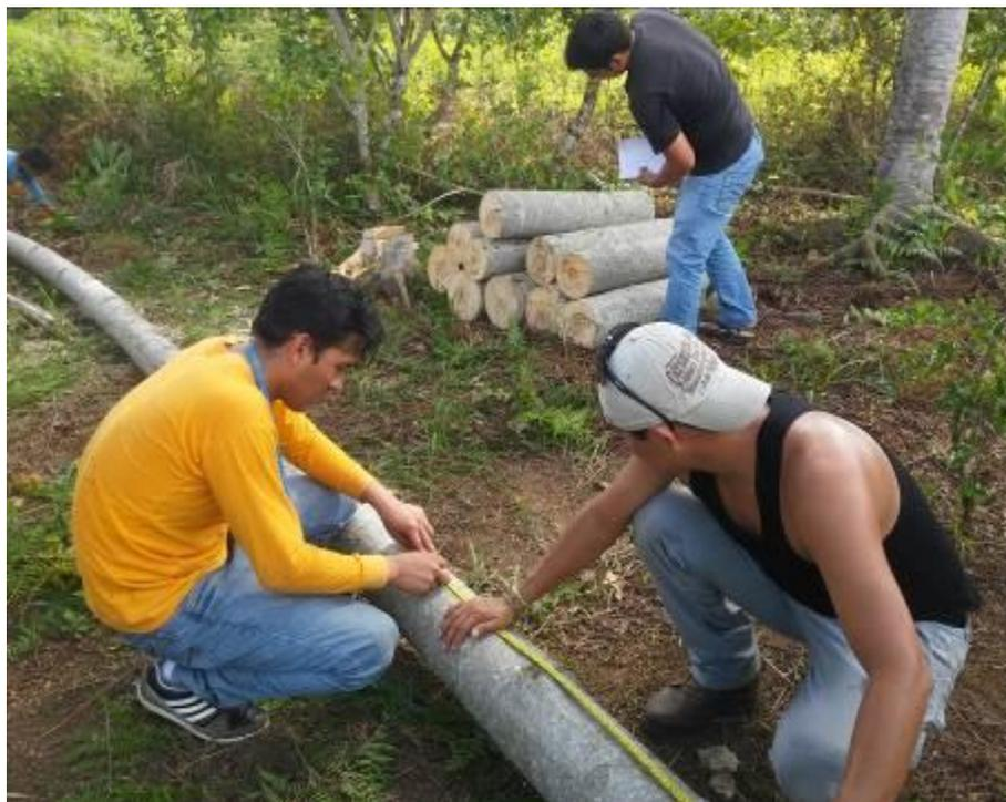
Figura 17. Medición de circunferencia para coeficiente de forma.
