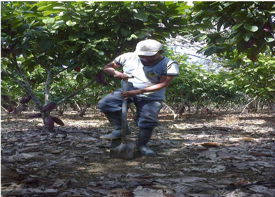
Figura 11. Extracción de muestra para evaluar la densidad aparente (cultivo de cacao)
