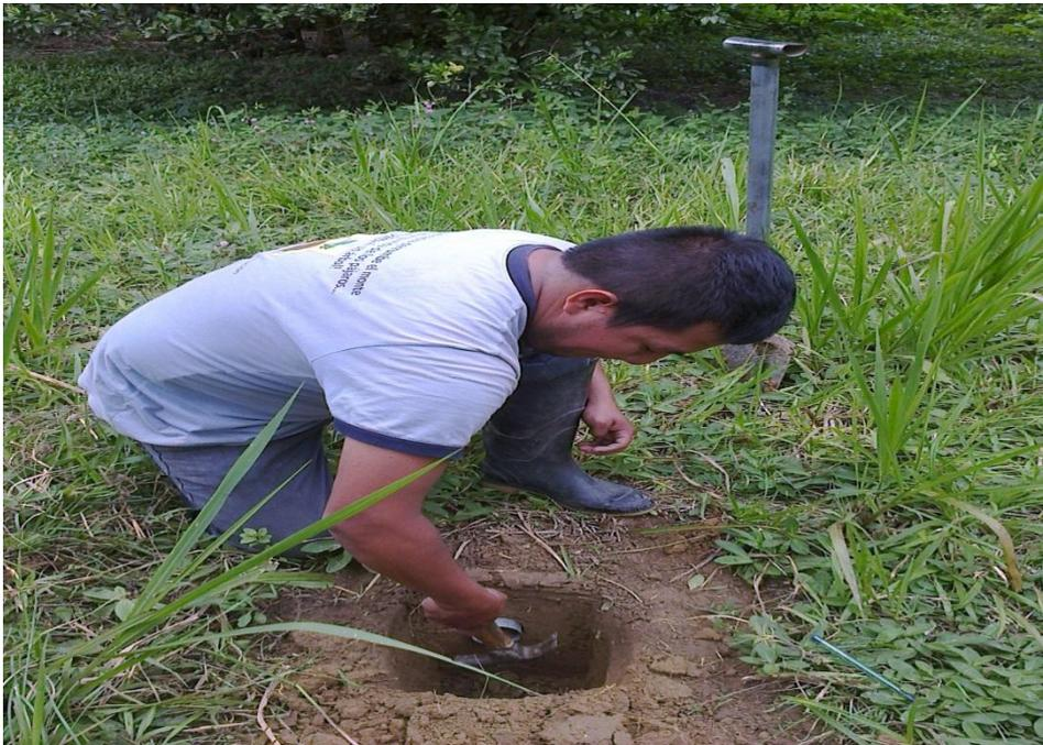
Figura 7. Extracción de muestra para evaluar la densidad aparente (cultivo de naranja)
