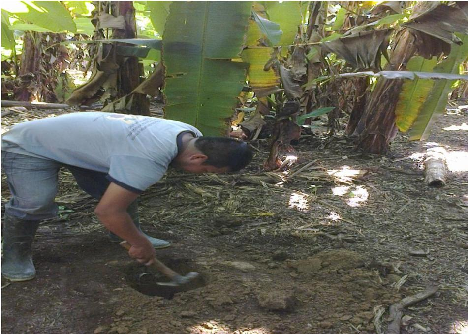
Figura 9. Extracción de muestra para evaluar la densidad aparente (cultivo de plátano)
