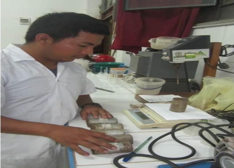
Figura 14. Pesado de muestras (cilindros muestreadores)
