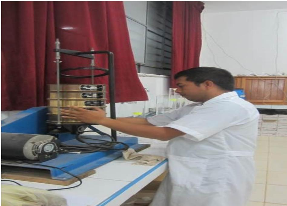
Figura 13. Tamizado de agregado del suelo
