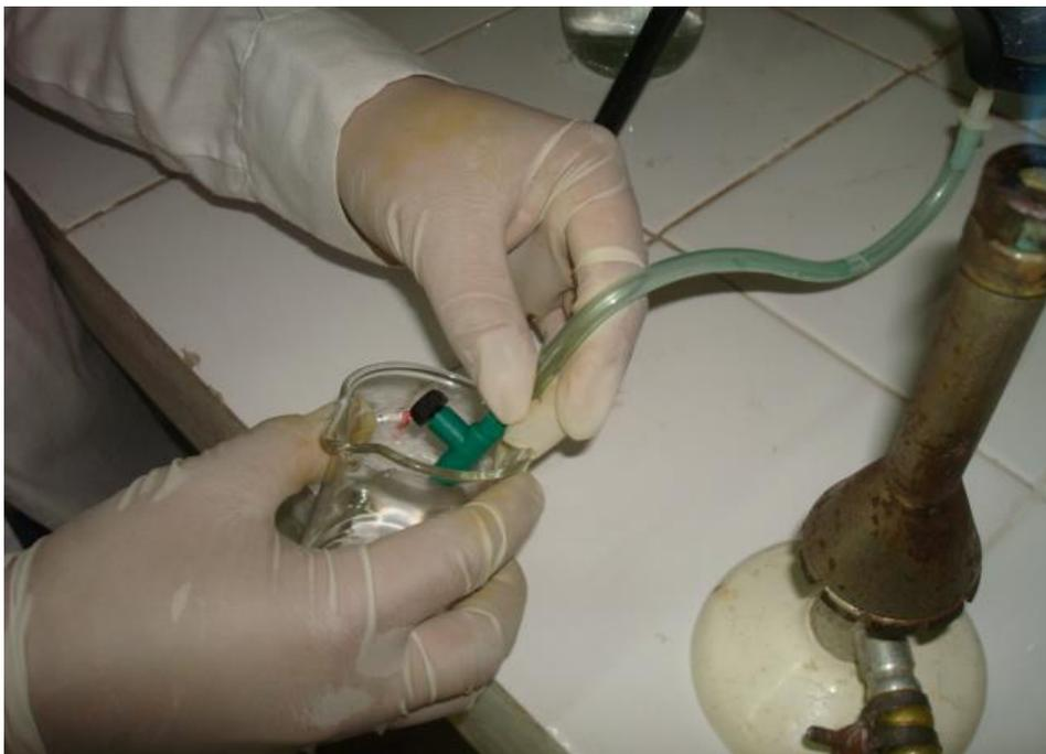
Figura 16. Obtención de los efluentes para mediciones de pH, OD, biomasa.
