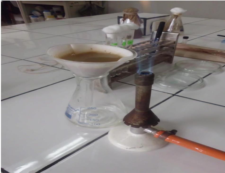
Figura 9. Filtrando el suelo para realizar las diluciones.
