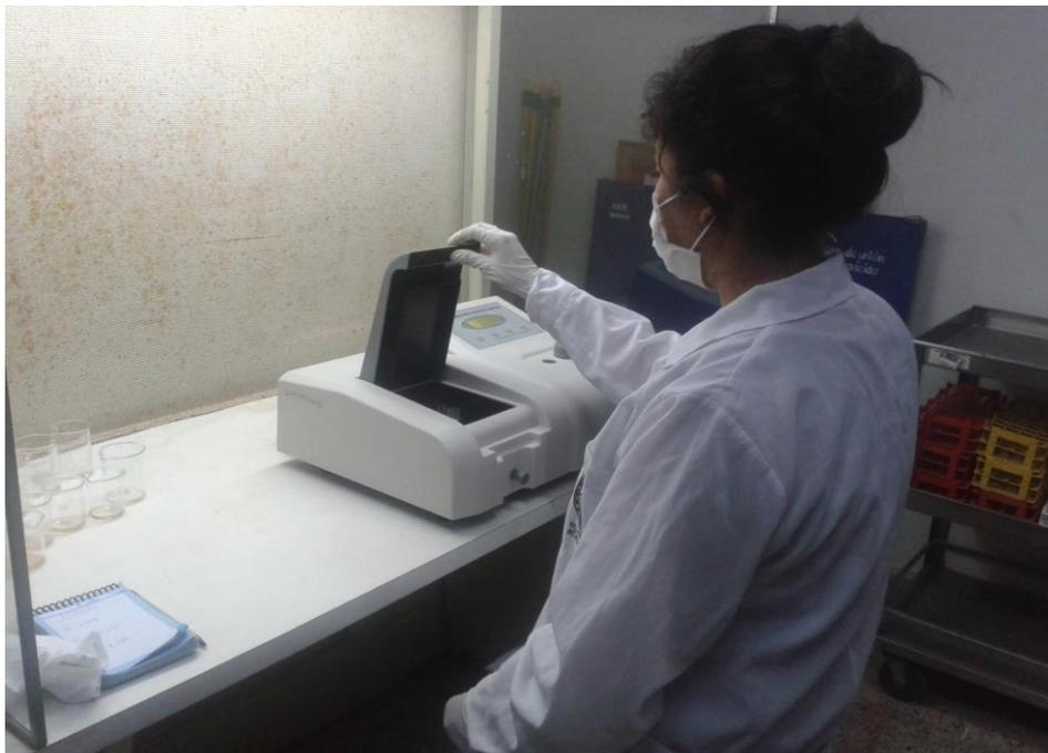
Figura 18. Medición en espectrofotómetro de la eficiencia de biorremediación del nitrito.
