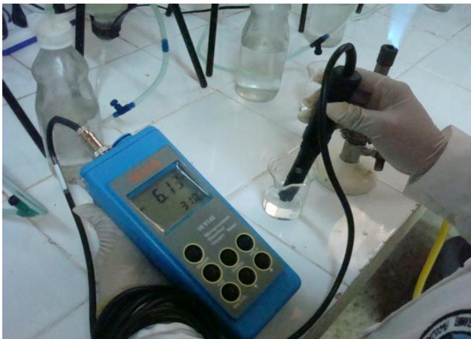
Figura 17. Medición de oxígeno disuelto.
