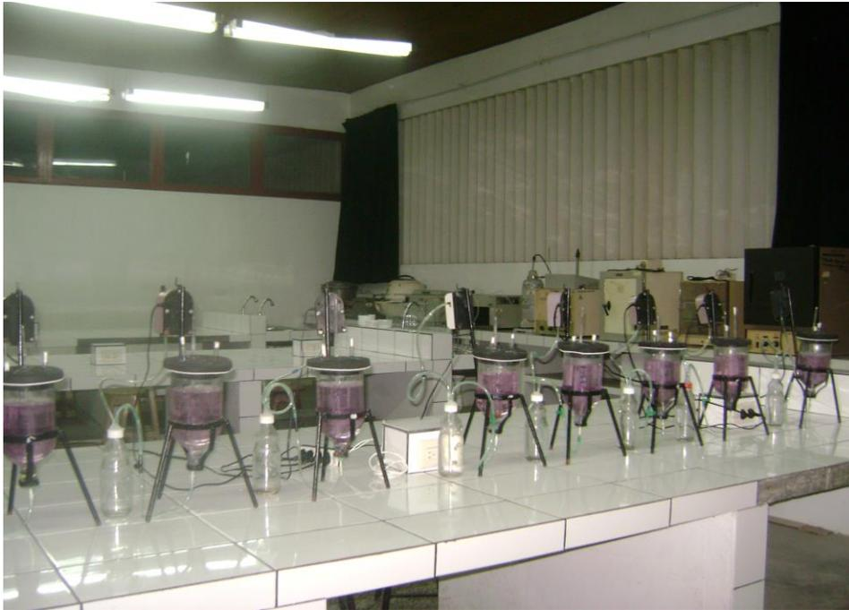
Figura 7. Desinfección/esterilización de los biorreactores air lift.
