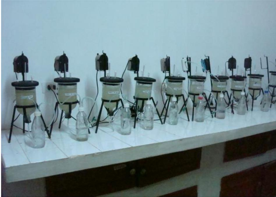
Figura 15. Biorreactores con el medio de cultivo y el inóculo en operación.
