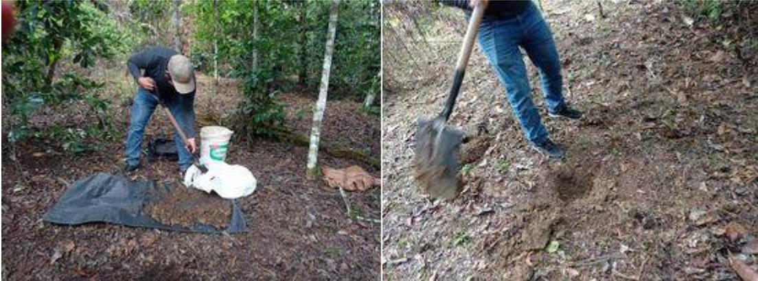
**Figura 19.** Toma de sub muestras y obtención de 1 kg para laboratorio y su análisis.
