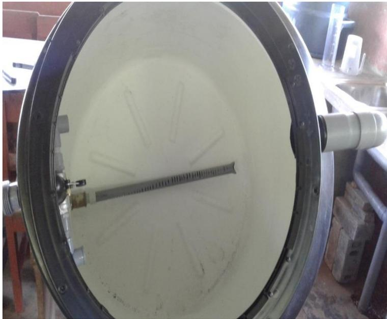
Foto 2. Vista de tubo de drenaje en el filtro
