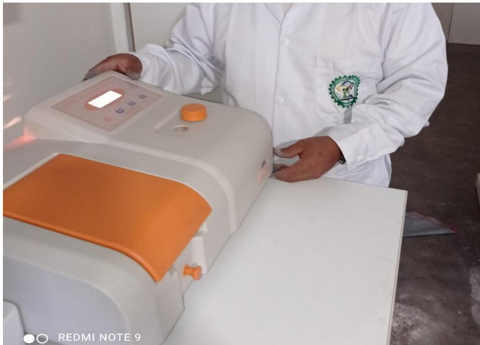
**Figura 14.** Medición de las absorbancias en el espectrofotómetro UV visible
