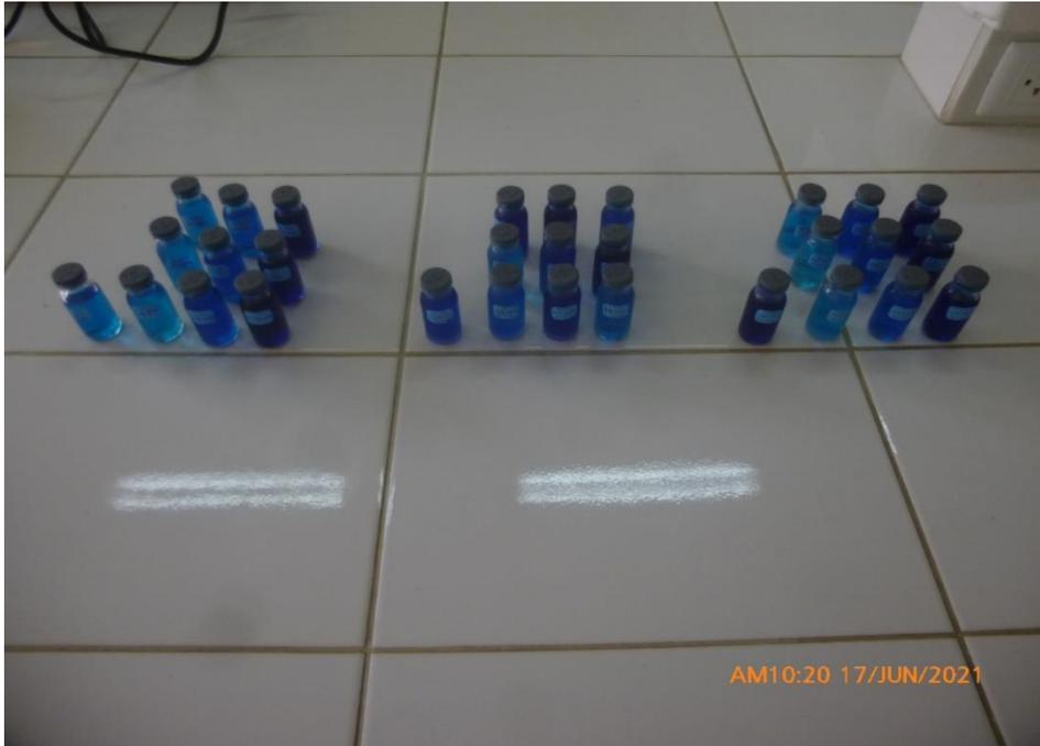
**Figura 15.** Muestras de las soluciones de azul de metileno para ser leídas en el espectrofotómetro.
