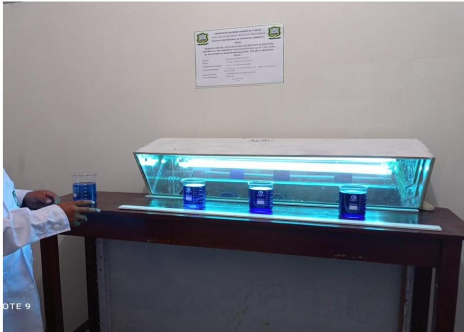
**Figura 11.** Equipo fotocatalítico utilizado en la investigación
