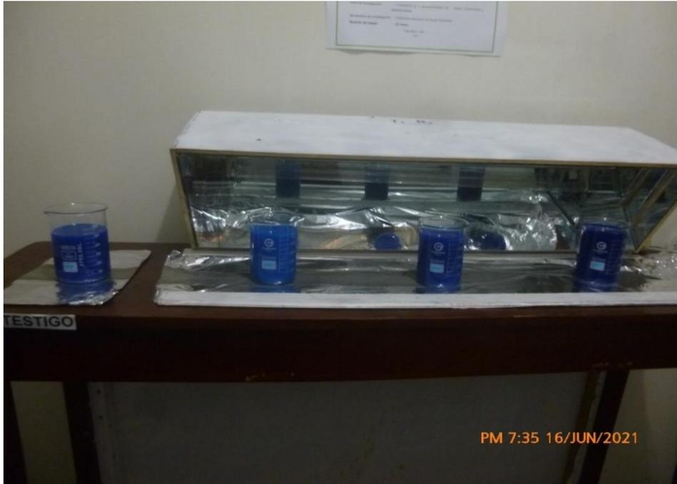
**Figura 13.** Aplicación del tratamiento fotocatalítico.
