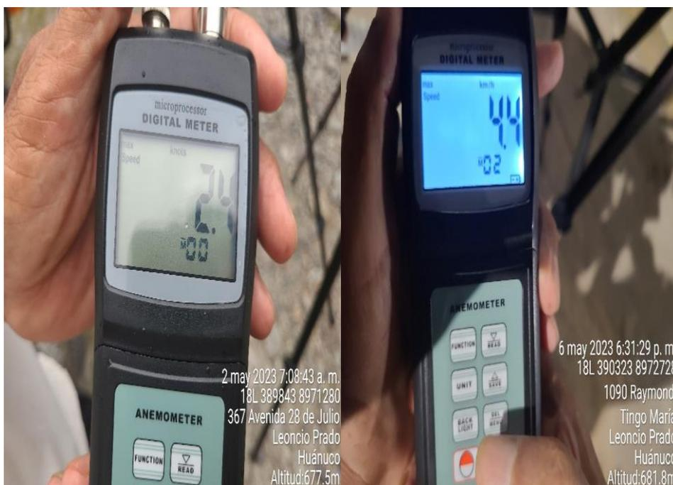
**Figura 26.** Medición de la velocidad del viento con el uso del Anemómetro
