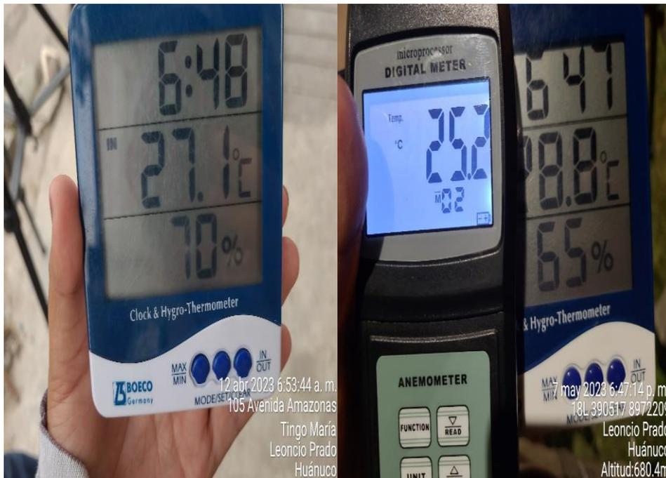
**Figura 25.** Medición de la temperatura y humedad relativa con el uso del Termohidrómetro
