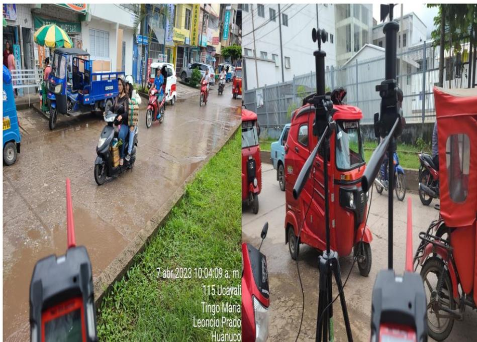
**Figura 30.** Medición de CO y CO<sub>2</sub> con muestreador de gases por puntos de monitoreo
