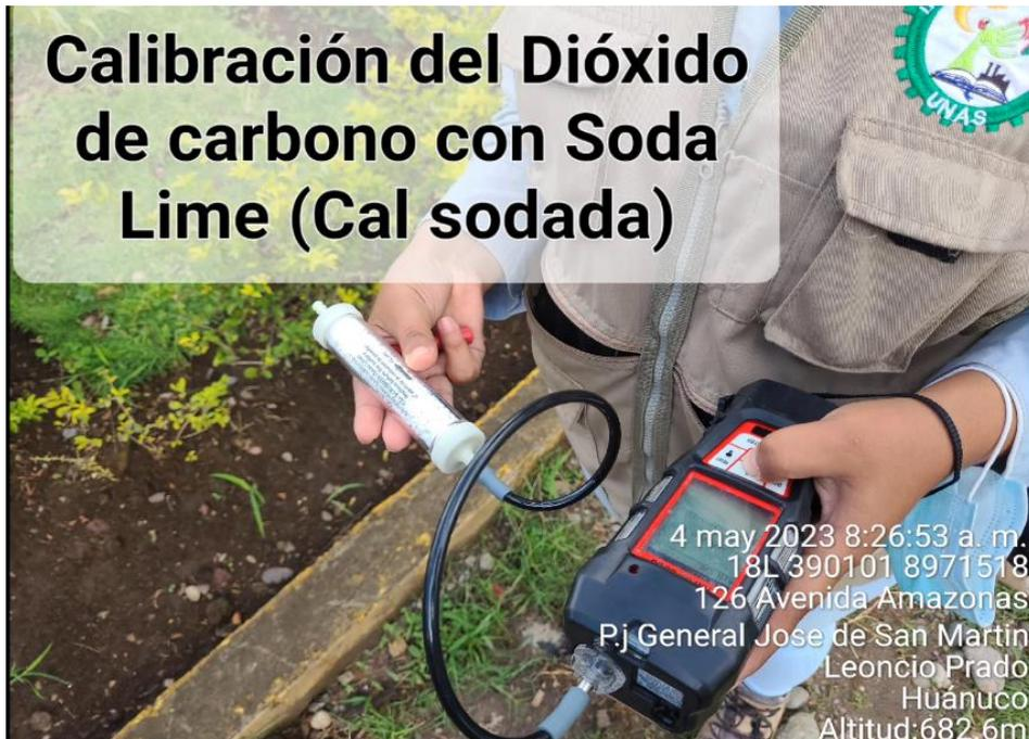
**Figura 27.** Calibración del muestreador de gases para el CO<sub>2</sub>
