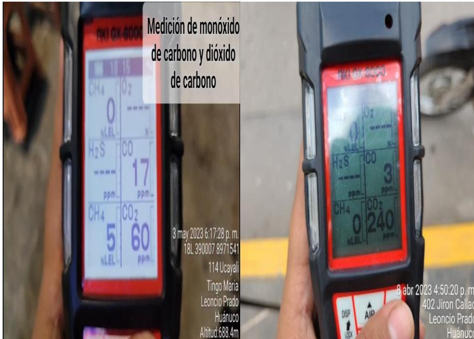
**Figura 29.** Medición de CO y CO<sub>2</sub> con muestreador de gases
