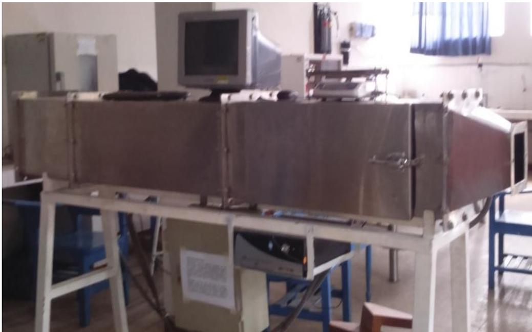
**Figura 2.** Secador por convección, interconectado a una computadora
