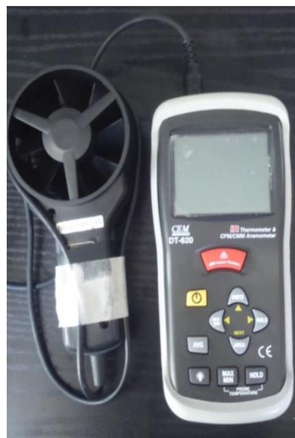
Equipo para medir la velocidad del aire de la secadora de bandejas
