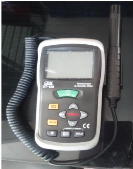
Equipo para medir la humedad relativa de la secadora de bandejas
