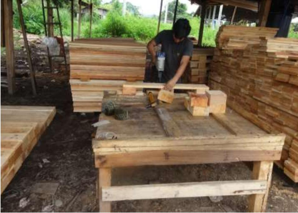
**Figura 32.** Armado de la base de las parihuelas.
