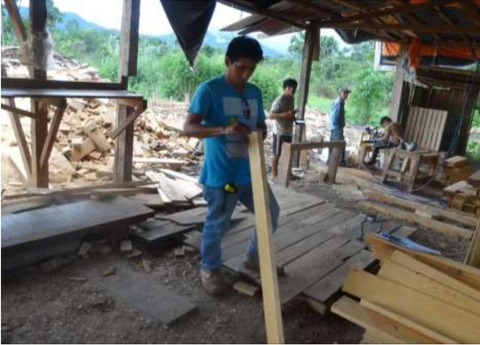
**Figura 28.** Verificación de las medidas de espesor y ancho de las tablas.
