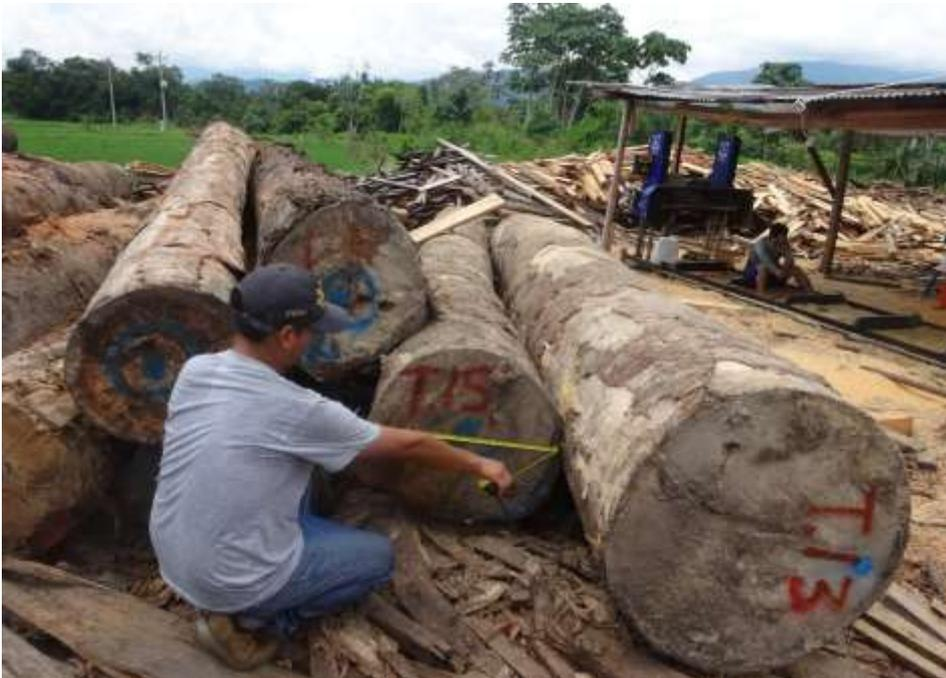
**Figura 23.** Medición de diámetro en cada extremo de la troza.
