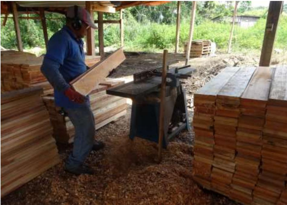
**Figura 27.** Calibración del ancho de las tablas en la Garlopa.
