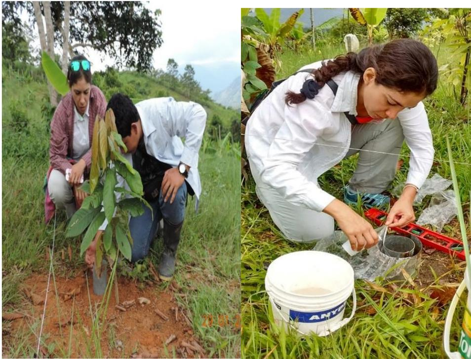
**Figura 61.** Técnica IV. Prueba de infiltración inicial Vs. Prueba de infiltración final en campo, usando cilindros.
