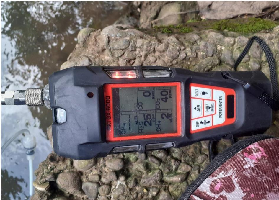
**Figura 30.** Equipo portátil multigas GX – 6 000
