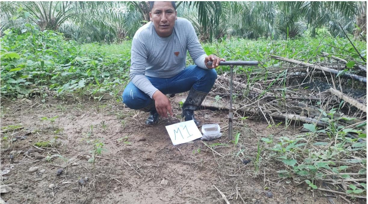
Foto 2. Extracción de muestras de suelo utilizando barrenador
