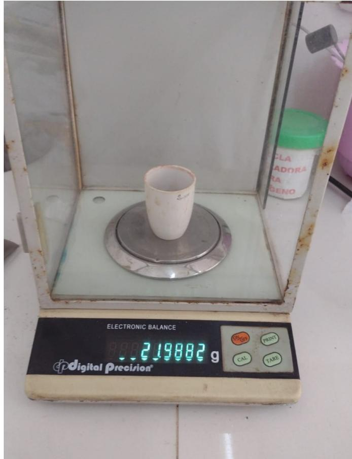
Foto 25. Pesado de muestra para determinación de fosforo (P)
