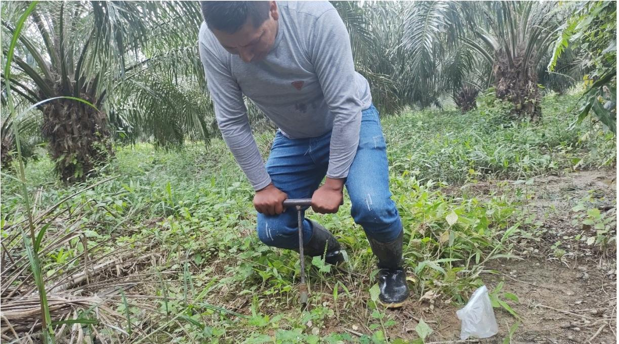
Foto 5. Extracción de muestras de suelo utilizando barrenador
