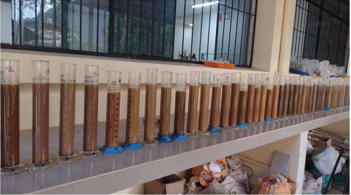
Foto 19. Tubos utilizados para la medición de la textura del suelo
