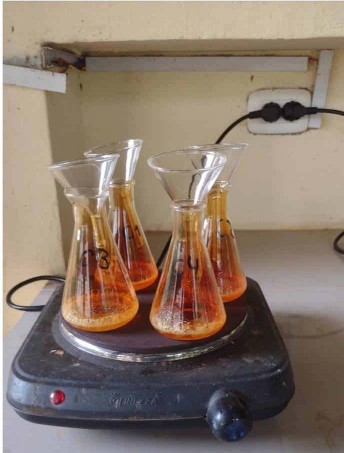
Foto 17. Determinación del nitrógeno (N)
