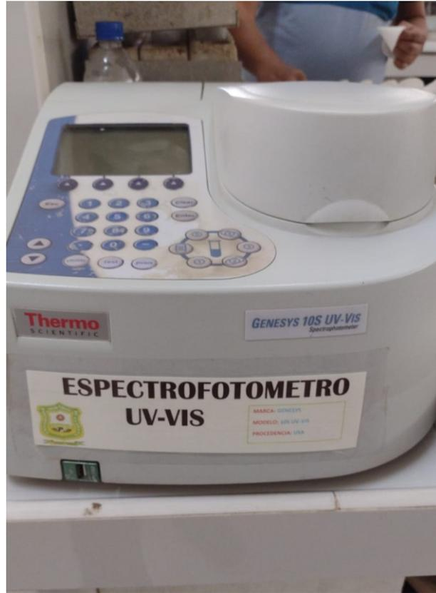
Foto 23. Equipo utilizado para análisis espectrofotométrico
