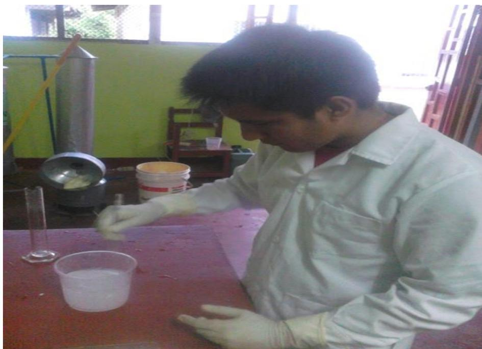
Figura 10. Preparación de solución de Hidróxido de Sodio (NaOH) a 1 mol
