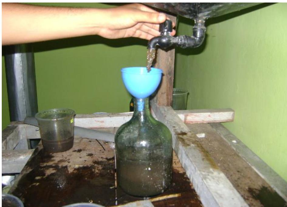
Figura 13. Extracción de lixiviados
