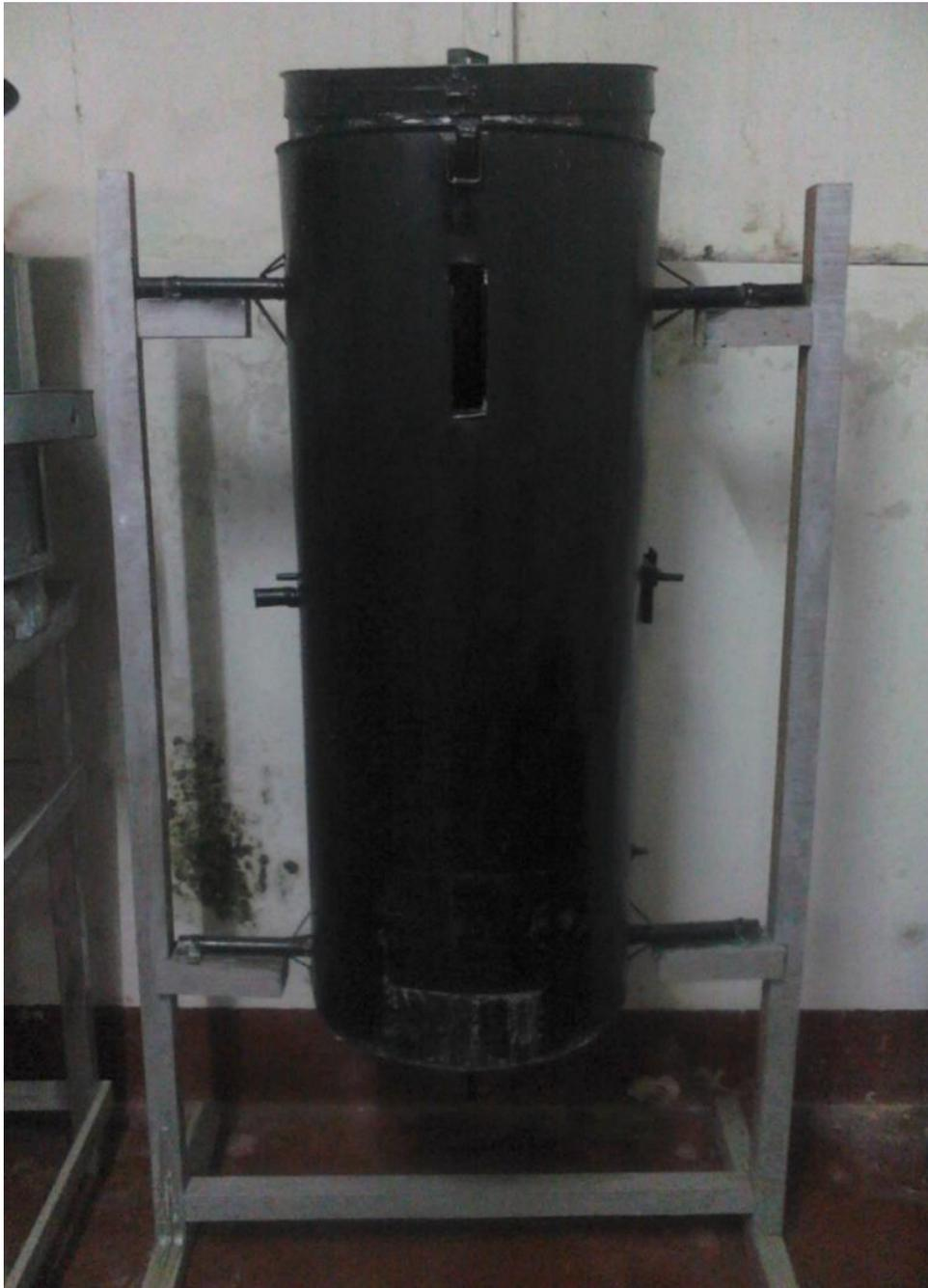
Figura 05. Reactor anaeróbico cilíndrico de triple cámara
