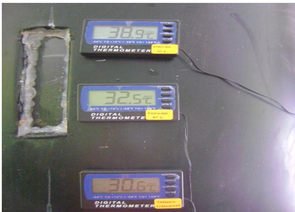
Figura 12. Recolección de datos de las temperaturas del reactor y temperatura ambiental mediante termómetros digitales calibrados
