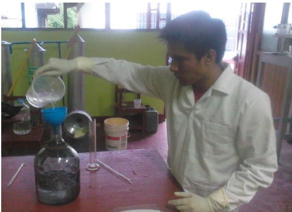
Figura 11. Agregado de solución de Hidróxido de Sodio (NaOH) a 1 mol al equipo de cuantificación de gas metano
