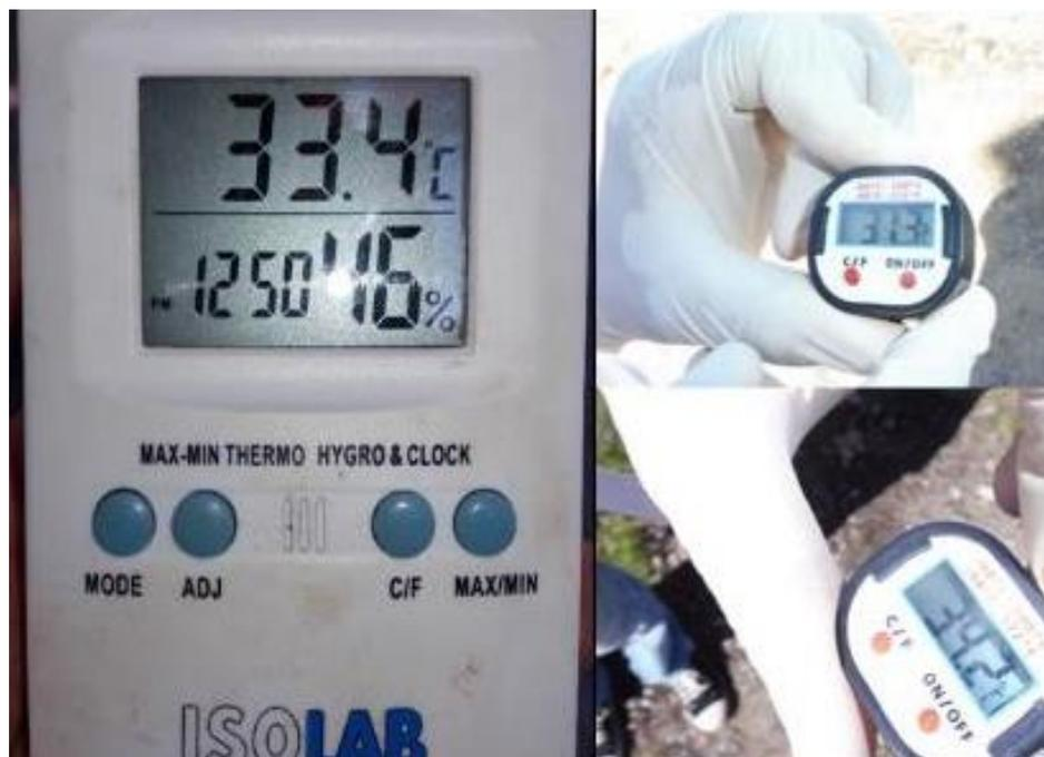
Figura 28. Determinación de la Humedad relativa y temperatura.
