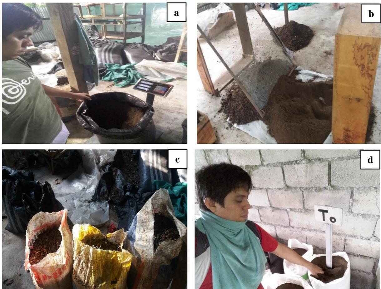
**Figura 28.** Pesado, tamizado y selección de muestras de compost, para su análisis en el laboratorio de suelos. a. Pesado de compost; b. Tamizado; c. Fracción gruesa (bagazo) y d. Fracción fina.
