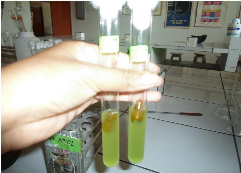
Foto 11. Interpretación de los resultados de todos los positivos para luego hacer la prueba confirmativa con el caldo *E. coli*. Posteriormente, a todos los positivos se realiza la prueba completada en el agar EMB
