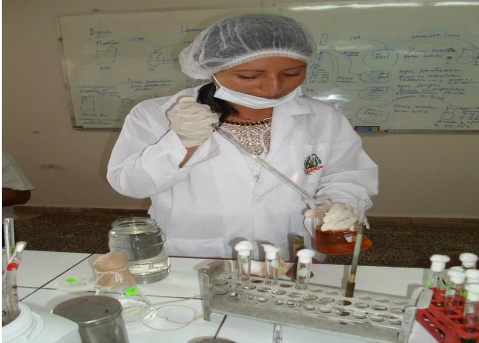
Foto 9. Adición del caldo *E. coli* en los tubos de ensayo
