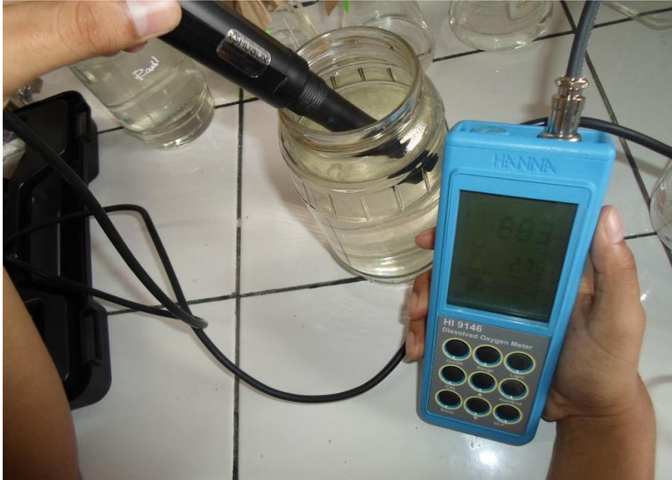
Foto 21. Medición del oxígeno disuelto con el oxímetro
