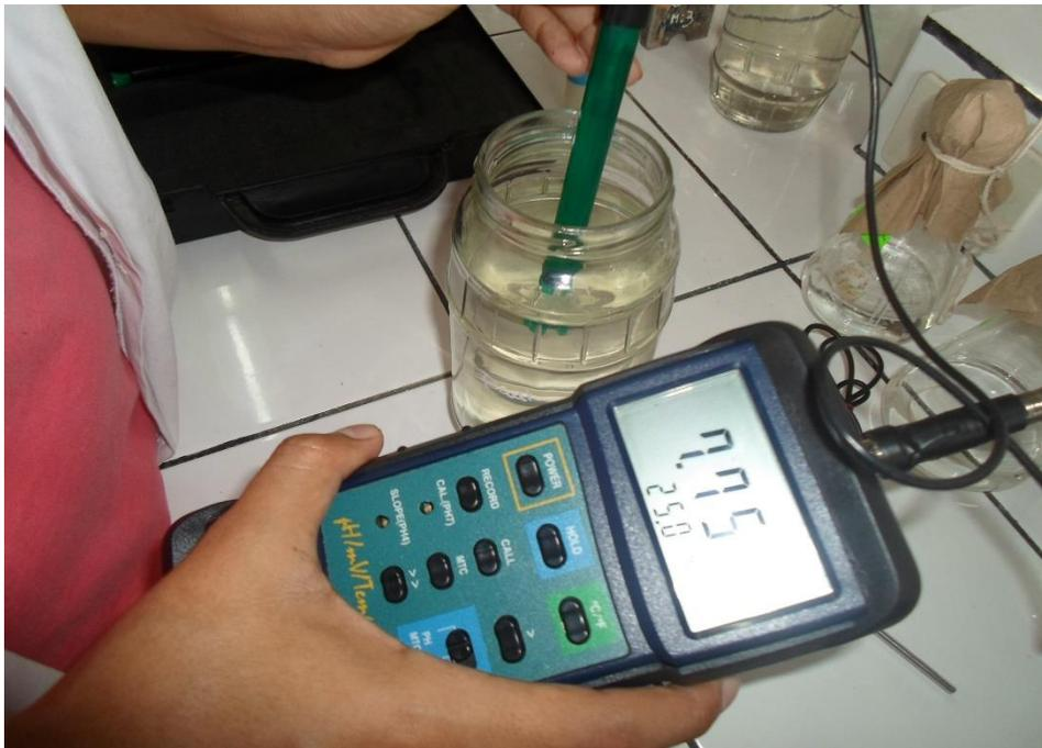
Foto 20. Determinación del pH con el pHmetro
