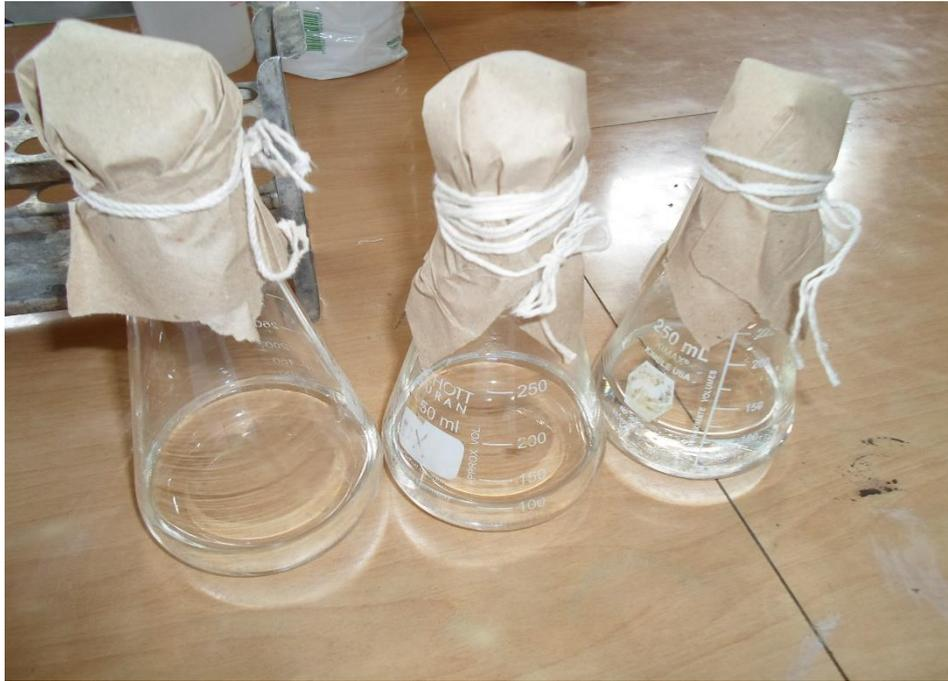
Foto 13. Pre-enriquecimiento: Adición de 25ml de muestra de agua en el caldo peptonado 1% y luego incubación a 37° por 24-48 horas.
