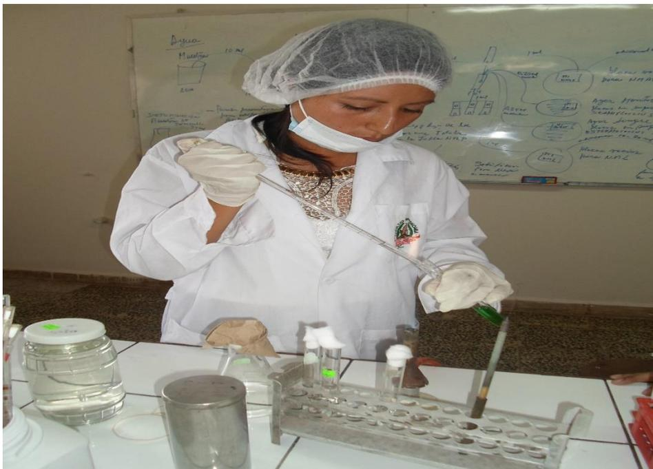
Foto 10. Adición de la muestra de agua 10ml en el caldo brilla para su incubación a 37°C por 24-48 horas
