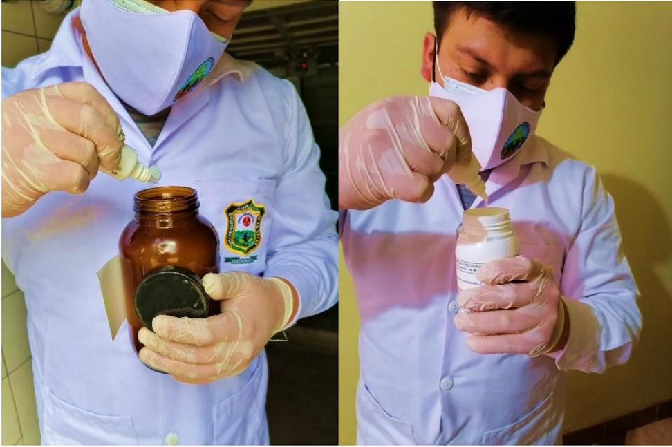
Agregando sulfúrico a la muestra
