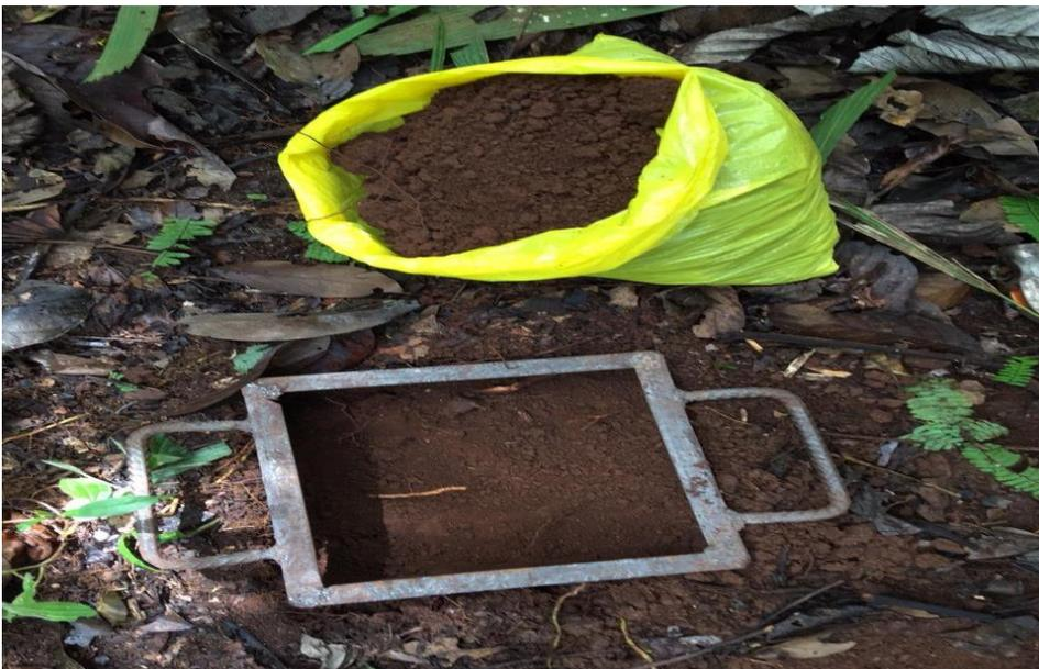
Figura 10. Extracción de muestras con el monolito
