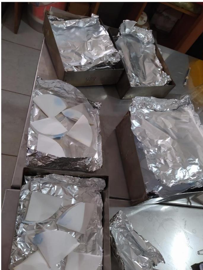
**Figura 34.** Operación de llevar a la estufa para la determinación de concentración del PAS.
