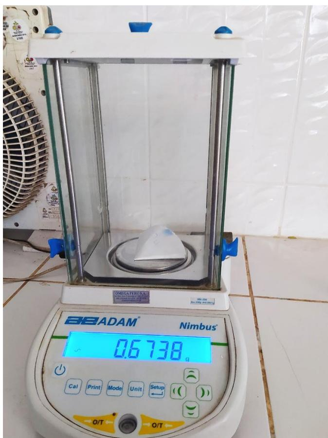
**Figura 33.** Operación de pesado de papel microfibra de vidrio filtro para la determinación de concentración del PAS.
