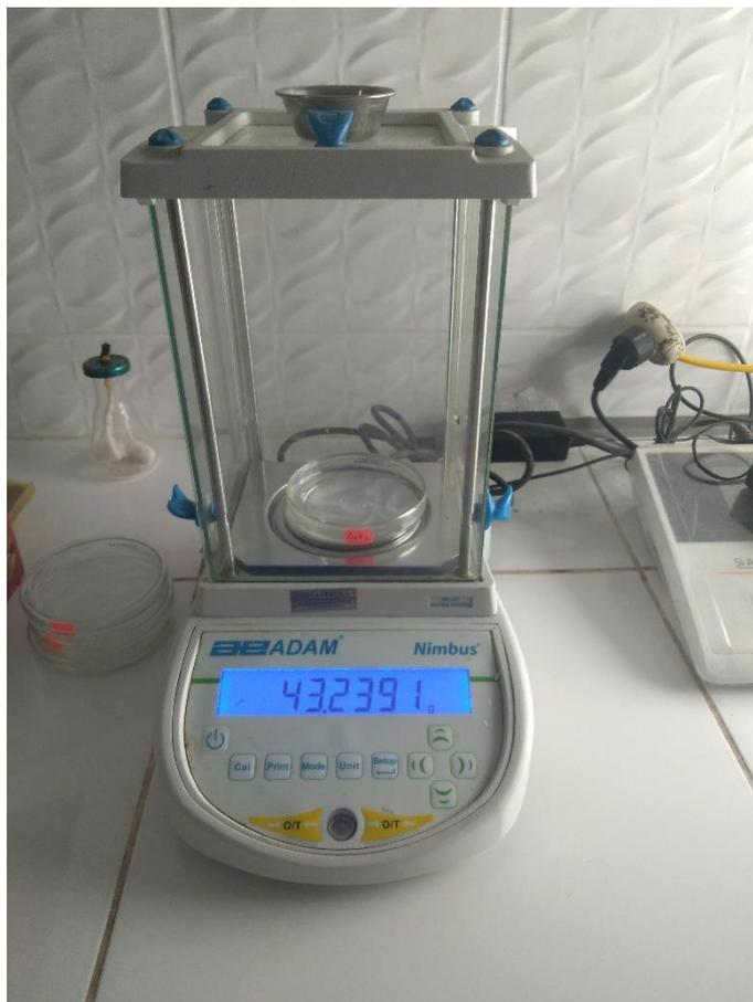
**Figura 28.** Operación de pesado de placas con vaselina para su posterior determinación de concentración del PAS.
