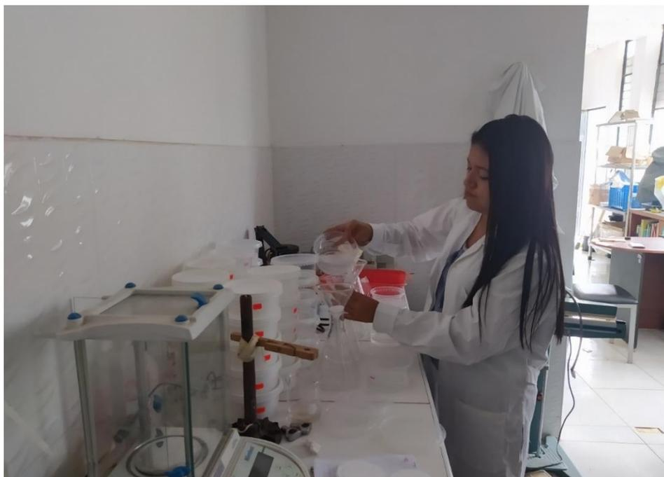
**Figura 31.** Operación de filtración para determinar la concentración del PAS
