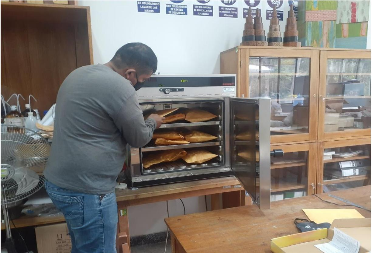
**Figura 15.** Secado de las muestras en la estufa
