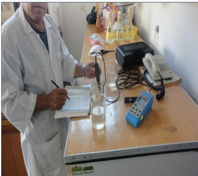
Figura17: Lectura de oxígeno disuelto en muestra de agua
