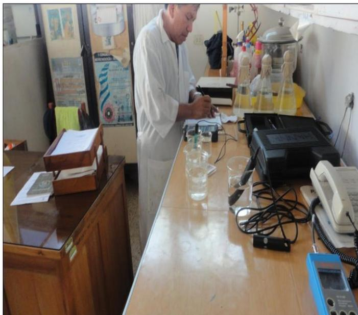
Figura14: Anotando Lectura de pH muestra de agua
