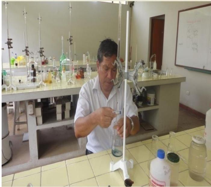
Figura15: Tiulaci3n para determinar la dureza del agua
