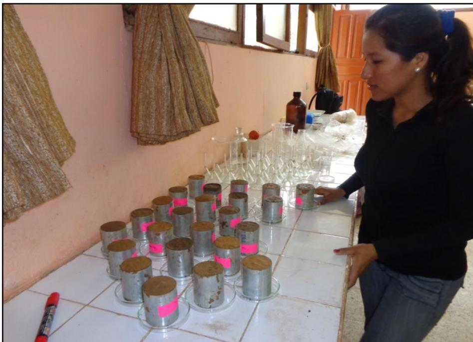
Figura 13. Cilindros muestreadores de suelos listos para ser llevados a la estufa.
