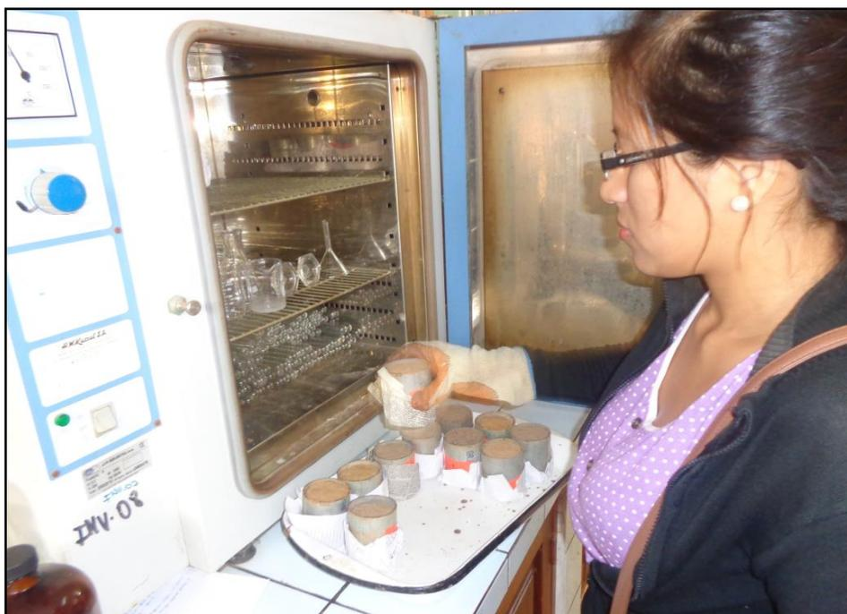
Figura 14. Colocando los cilindros muestreadores de suelo en la estufa a una temperatura de 105 °C.
