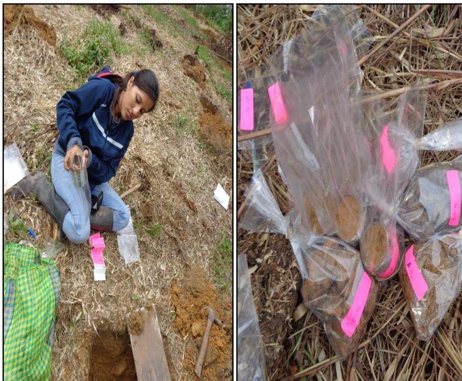
Figura 12. Toma de muestras de suelo para medidas de carbono y densidad aparente.
