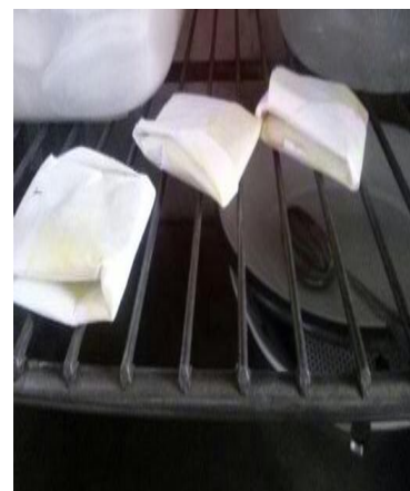
Foto N° 27: secar los cartuchos en la estufa 45 o 50°C por 2 horas (para usar en fibra).
