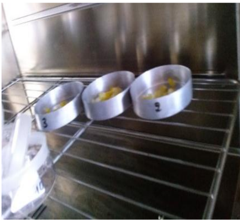
Foto N° 7: El recipiente con Olluco se lleva a la estufa en temperatura de 55 o 60 °C por seis o siete horas.
