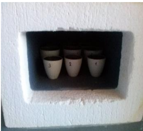
Foto N° 15: Poner los crisoles en la mufla a una temperatura de 65 o 80°C por 12 horas.
