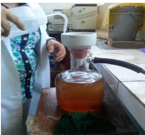
Foto N° 32: Realizar el primer enjuague y echar 200ml de NaOH (1.25%).y realizar el segundo enjuague con agua caliente y alcohol
