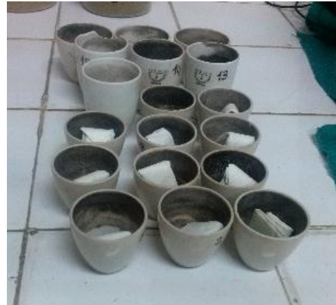
Foto N° 12: Poner los cartuchos en los crisoles.
