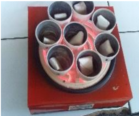
Foto N° 36: Quemar los crisoles con los cartuchos y echar alcohol.
