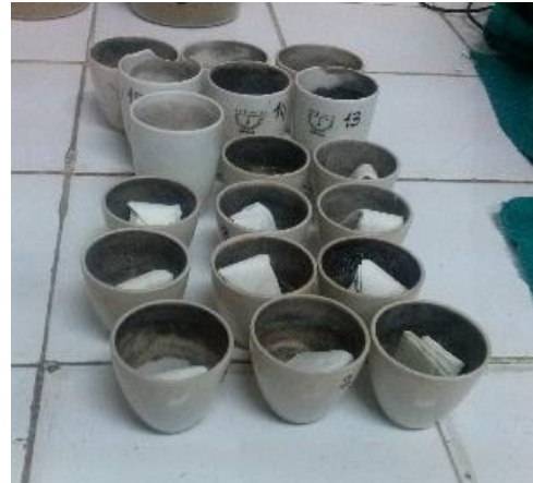
Foto N° 35: Poner los cartuchos en los crisoles.
