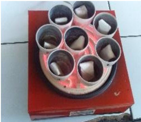
Foto N° 13: Quemar los crisoles con los cartuchos y echar alcohol.
