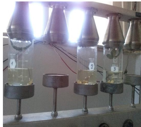
Foto N° 31: Echar 200ml de H 2 SO 4 (1.25%) por 30min.
