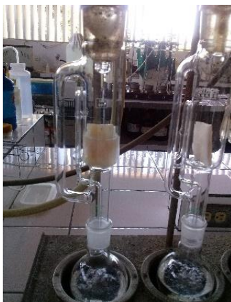
Foto N° 26: Poner en el aparato de soxhlet el cartucho con el olluco y el hexano o éter de petróleo; en el cual se pesa el balón (3h).
