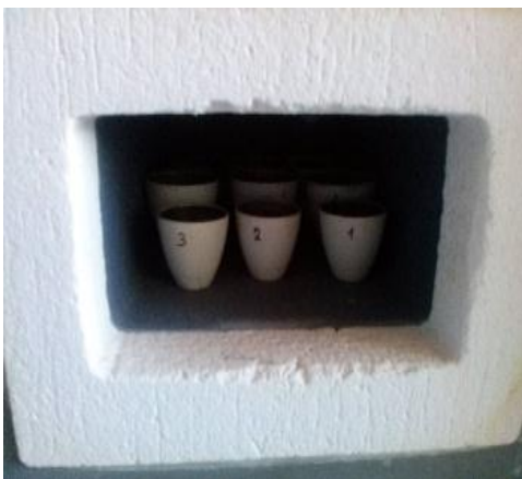
Foto N° 38: Poner los crisoles en la mufla a una temperatura de 65 o 80°C por 12 horas.
