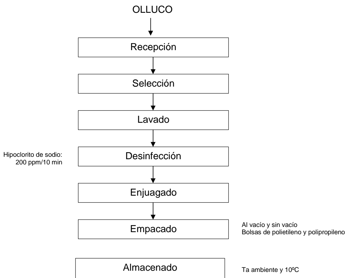
Figura 5. Flujo de operaciones para la conservación del olluco entero.
