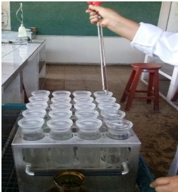
Foto N° 19: Echar ácido sulfúrico concentrado en la muestra.
