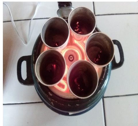
Foto N° 37: Quemar completamente todo la muestra.
