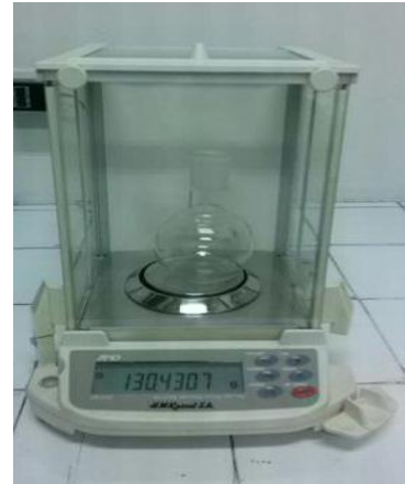
Foto N° 29: Luego de enfriar y pesar el balón con grasa.
