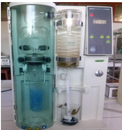
Foto N° 21: Usar el equipo para destilación usando hidróxido de sodio (50%) y ácido bórico.
