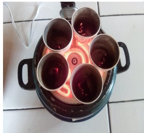
Foto N° 14: Quemar completamente todo la muestra.
