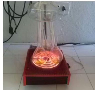
Foto N° 20: Poner a calentar o usar el equipo digestor por 2 horas.
