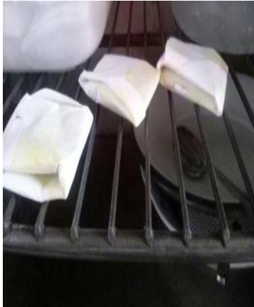
Foto N° 34: Secar los cartuchos en la estufa a una temperatura de 45°C por 2 horas.
