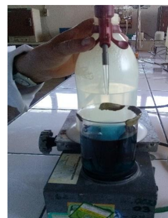
Foto N° 22: Titular con ácido clorhídrico en 0.01 N
