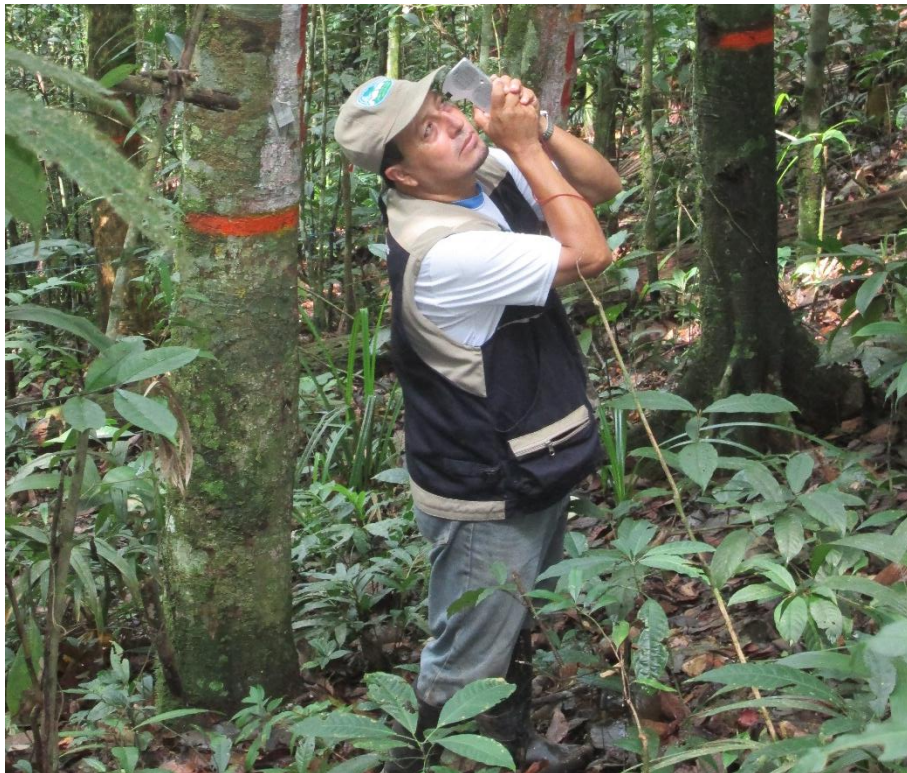
Figura 12. Lectura del clinómetro para obtener la altura total.
