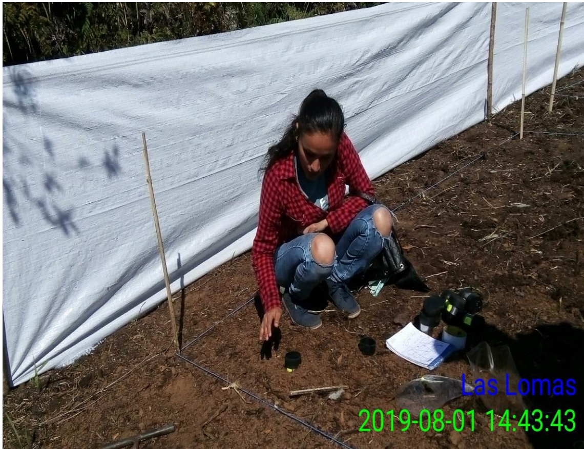
Figura 38. Muestreo con cilindros para la densidad aparente.
