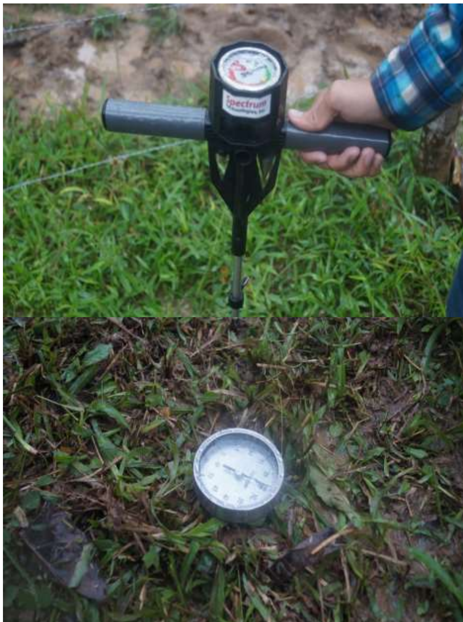
Figura 7. Geotermómetro (temperatura del suelo) y penetrómetro (nivel de resistencia a la penetración vertical del suelo) utilizados
