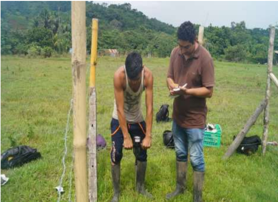
Figura 4. Medición de la compactación de suelo.
