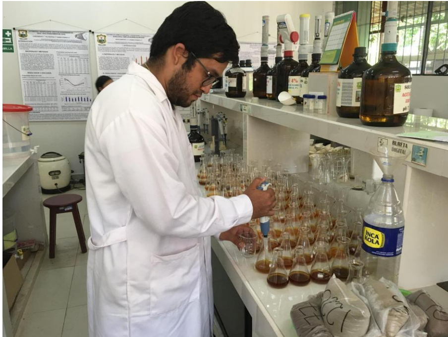
Figura 12. Preparación de extractos para el espectrofotómetro: prueba ácida para lectura
