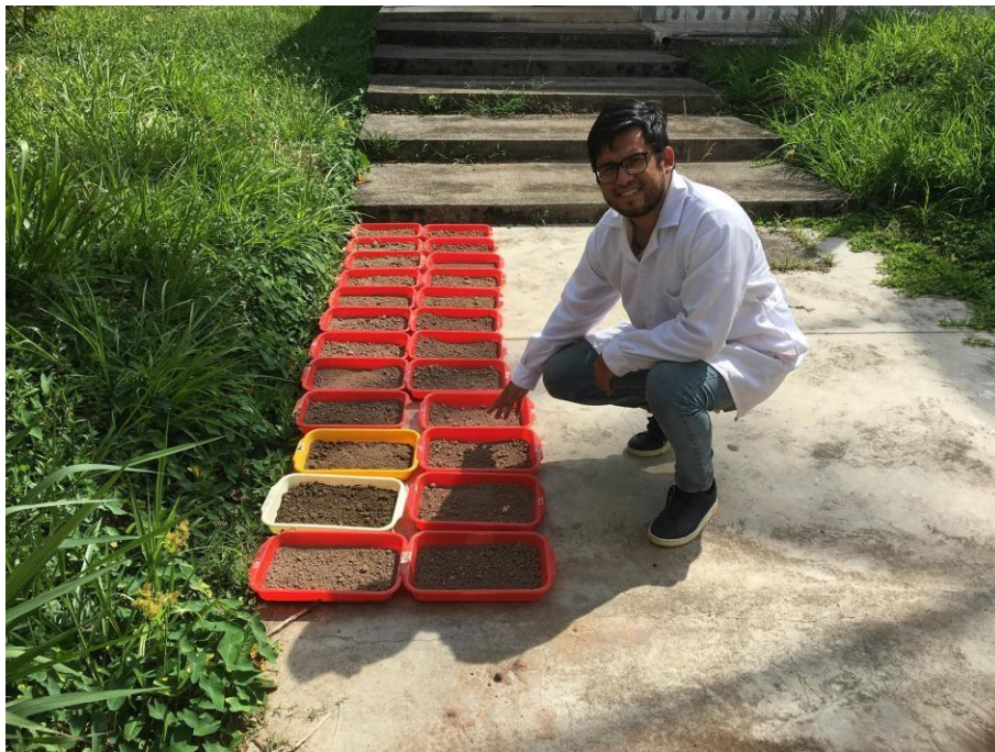
Figura 7. Secado a sol directo y etiquetado de las muestras de suelo recolectadas en campo
