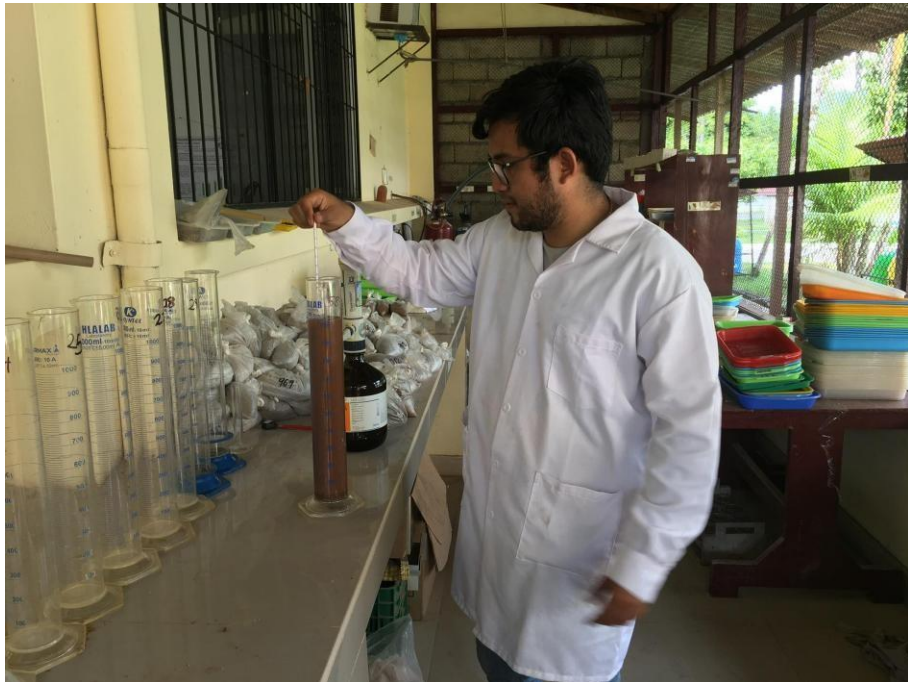
Figura 9. Indicador físico: Medición y clasificación de la textura de las muestras de suelo
