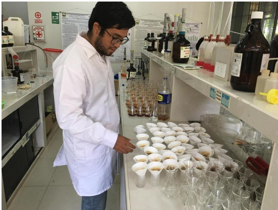
Figura 11. Preparación de extractos para el espectrofotómetro: filtrado de suelos
