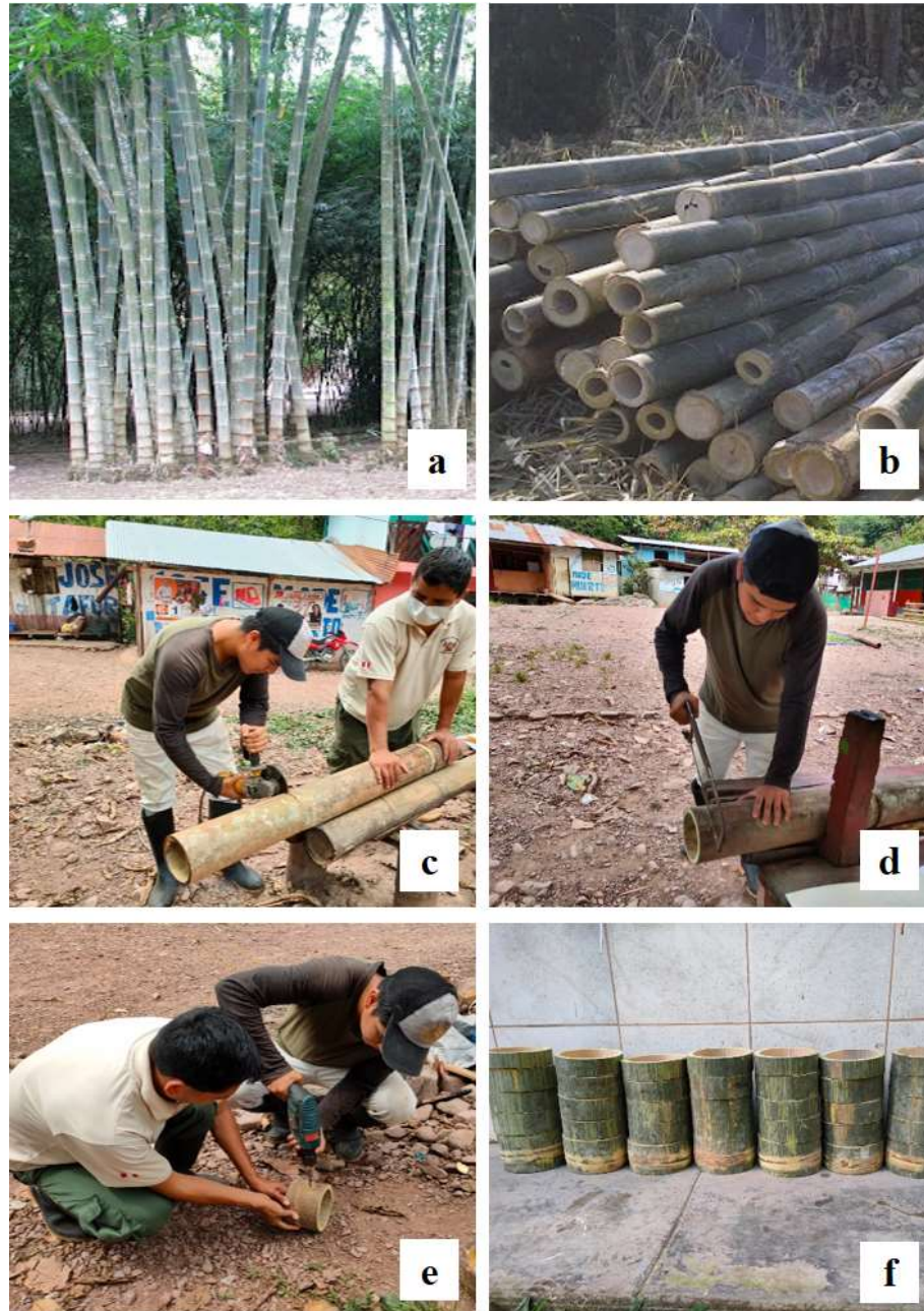
Figura 4. Mata de bambú (a), culmos cortados (b), corte de culmo (c y d), apertura de orificio (e) y caja racional (f).
