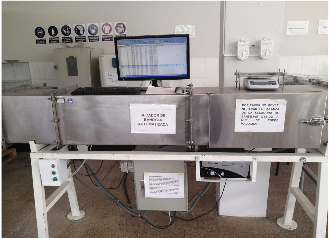
**Figura 2:** Secador por convección, interconectado a una computadora.
