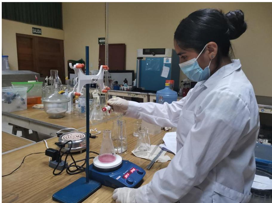
**Figura 37.** Determinación del peso equivalente de la pectina
