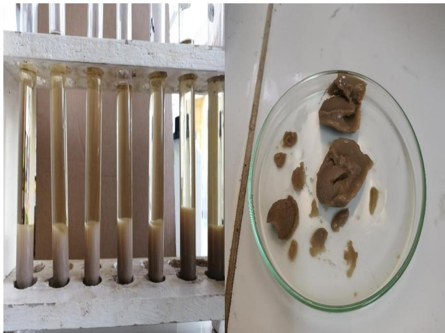
**Figura 33.** Pectina coagulada después del proceso de centrifugación
