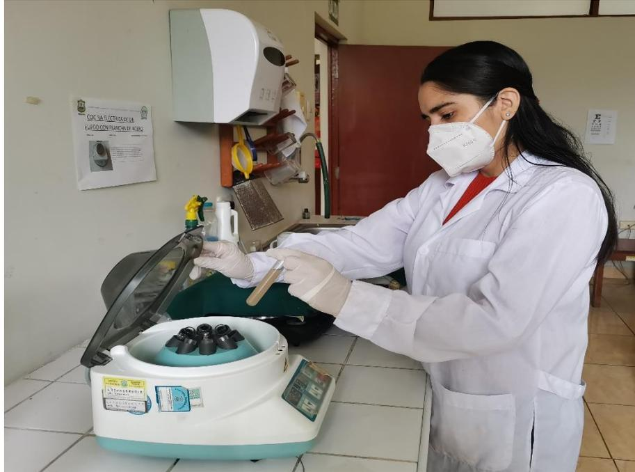
**Figura 32.** Separación del alcohol restante en la pectina precipitada por centrifugación (6000 rpm)
