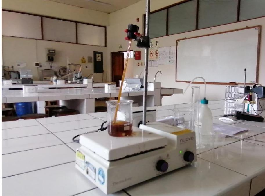
**Figura 40.** Determinación del grado de gelificación de la pectina
