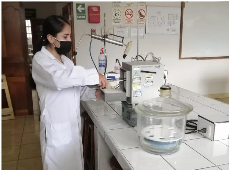
**Figura 41.** Determinación de cenizas de la pectina
