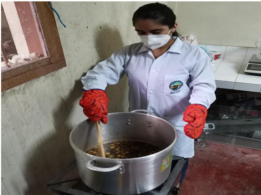
**Figura 29.** Hidrólisis ácida (pH = 2,5) con agitación constante de 40 a 60 minutos
