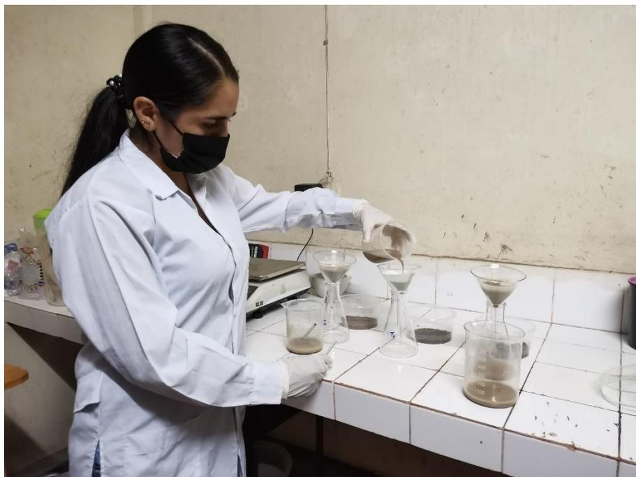
**Figura 49.** Preparación de las soluciones de suelo tratado con pectina para las pruebas de fitotoxicidad
