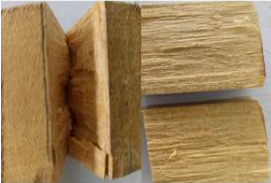
Figura 6. Determinación del grano por las muestras de L. procera
