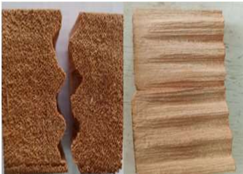
Figura 5. Determinación del grano para las muestras de V. grandis
