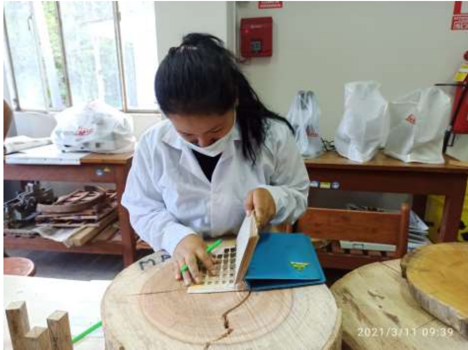
Figura 25. Determinación de color en muestra de rodajas
