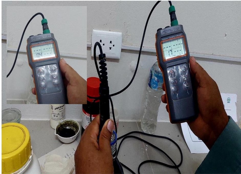
**Figura 55.** Medición de Oxígeno Disuelto.
