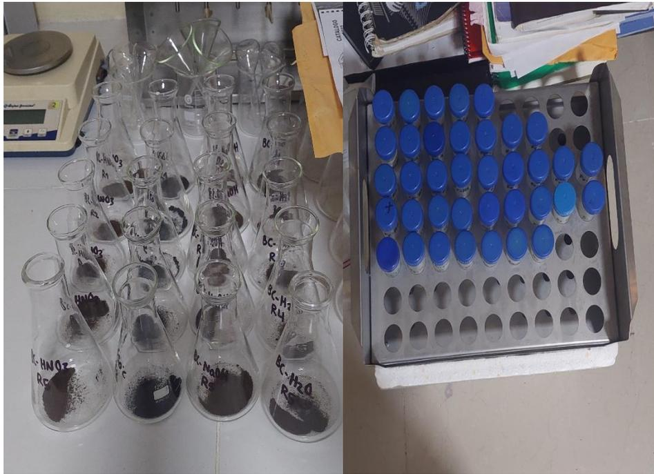
**Figura 75.** Digestión ácida del bioadsorbente recuperado.
