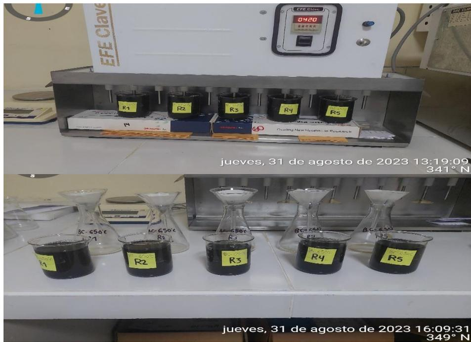
**Figura 71.** Agitación y filtrado de la prueba 4.
