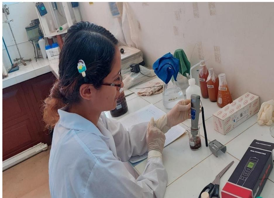
**Figura 44.** Medición del pH en las borras de café con modificaciones.
