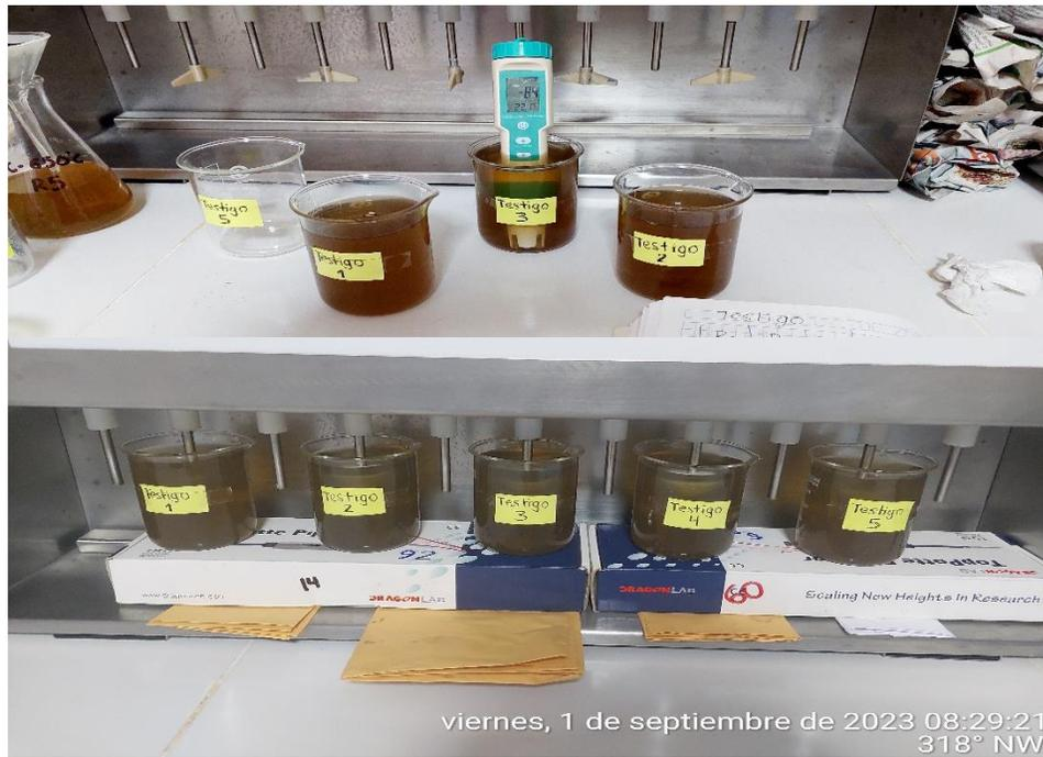
**Figura 67.** Regulación de pH y agitación de la prueba 0.
