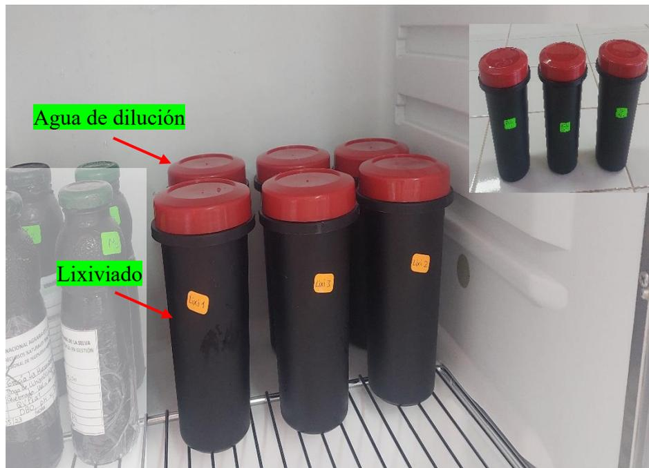
**Figura 56.** Medición de Demanda Bioquímica de Oxígeno.
