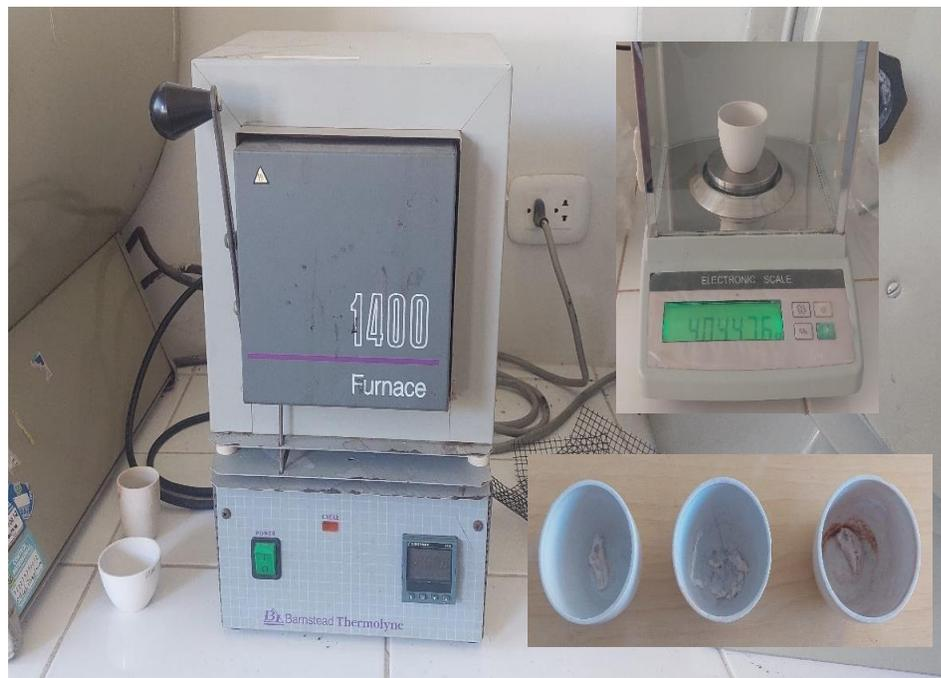
**Figura 58.** Medición de Sólidos Totales Volátiles y Sólidos Suspensos Totales.
