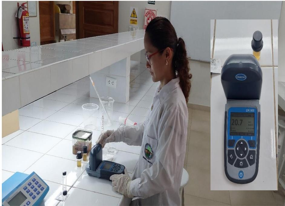
**Figura 59.** Medición de nitratos y nitritos.
