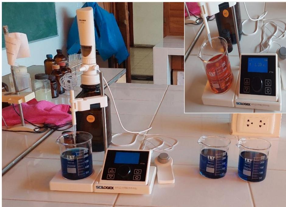
**Figura 62.** Titulación con ácido sulfúrico para determinar nitrógeno total.
