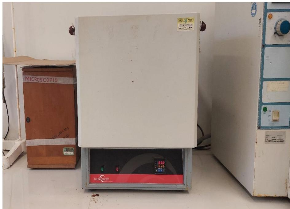
**Figura 48.** Calcinación de la BC a 650°C (laboratorio de suelos).
