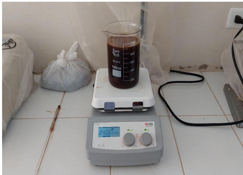
**Figura 42.** Agitación magnética para la impregnación del NaOH en la BC.
