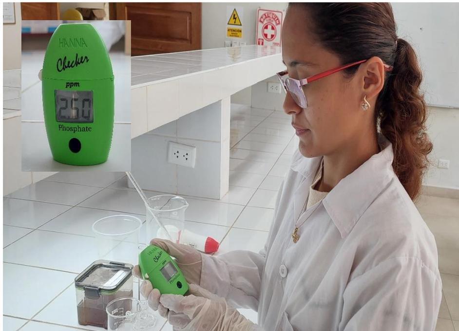
**Figura 60.** Medición de fosfatos.
