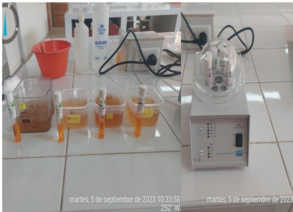
**Figura 76.** Mediciones de la DQO después del proceso de adsorción.
