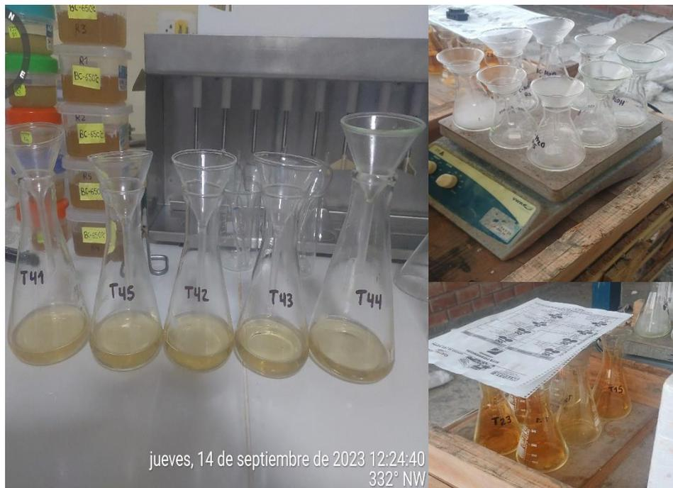
**Figura 74.** Digestión ácida de los remanentes de lixiviado.
