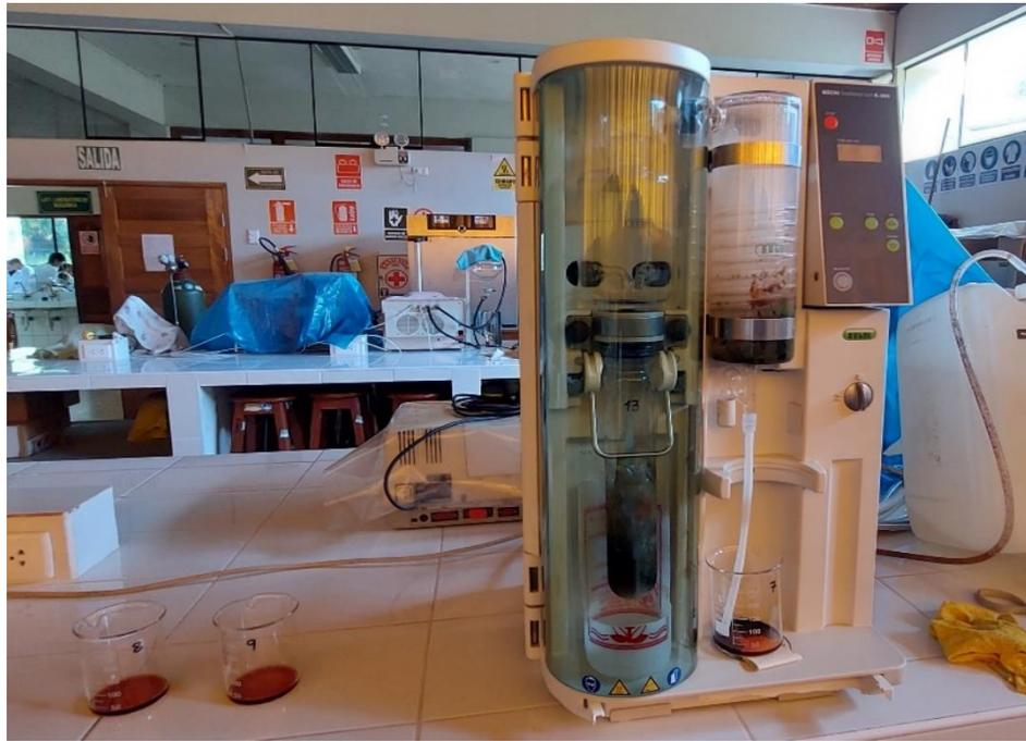
**Figura 61.** Destilación por el método Kjeldahl.
