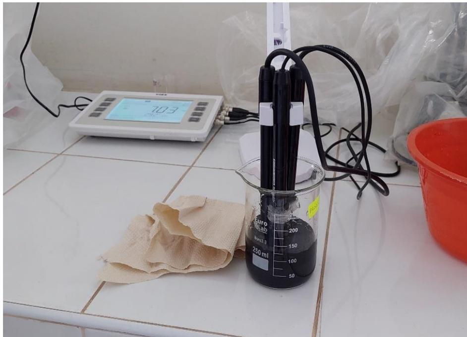
**Figura 50.** Mediciones en la BC – 650°C (temperatura, CE, TDS y ORP).
