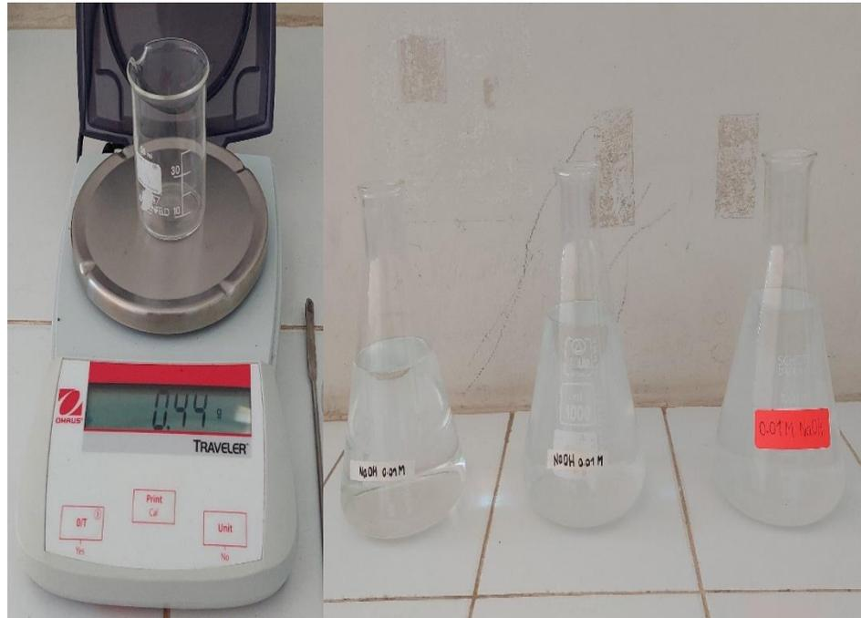
**Figura 41.** Preparación de las soluciones de NaOH al 0.01M.
