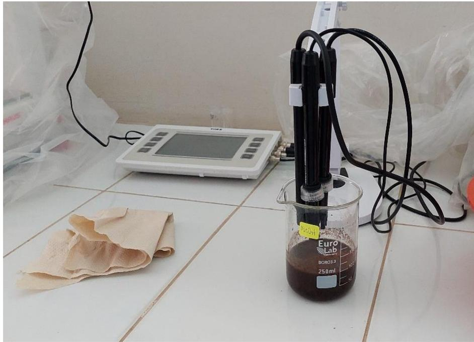
**Figura 47.** Mediciones en la BC – NaOH (temperatura, CE, TDS y ORP).
