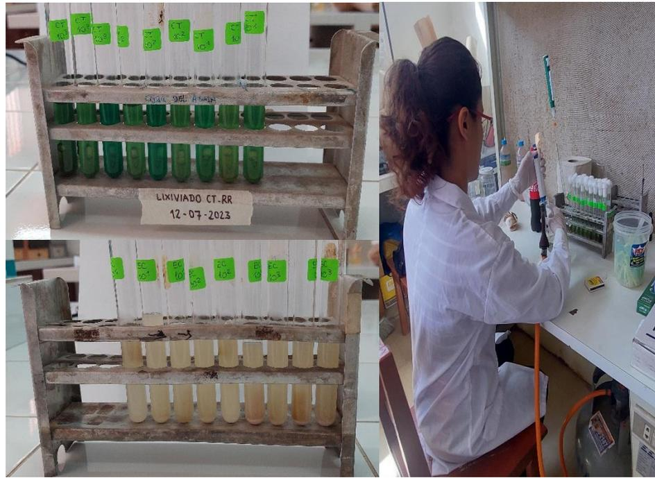
**Figura 65.** Determinación de coliformes totales y *Escherichia coli*.
