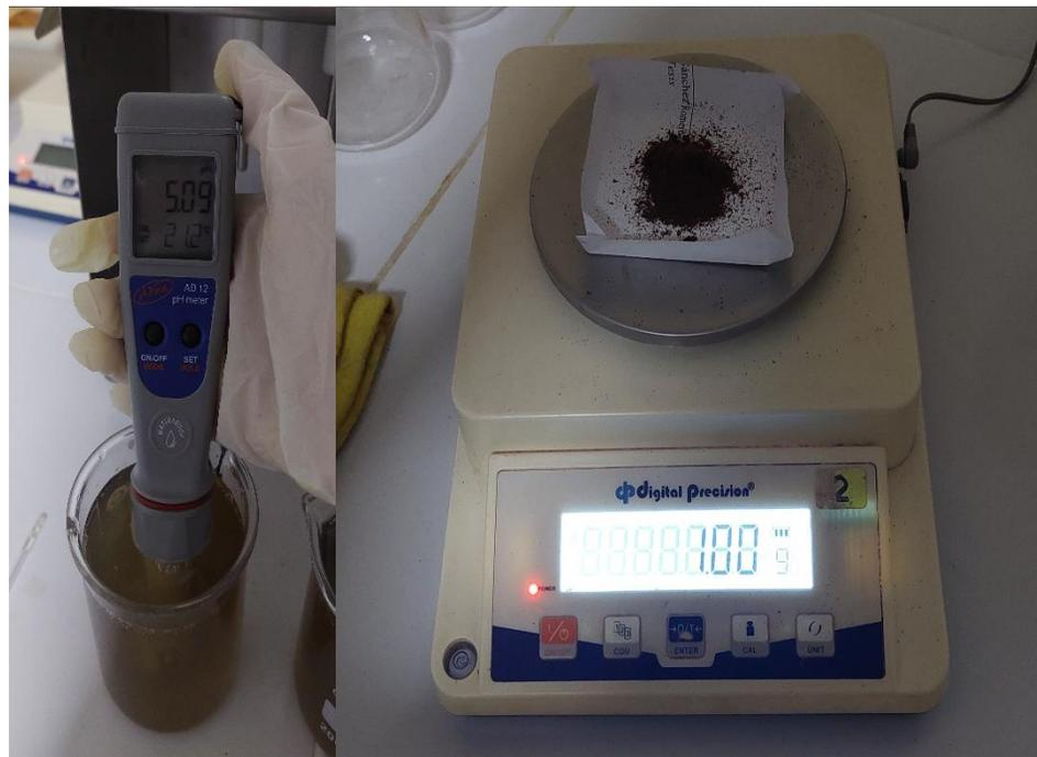
**Figura 66.** Regulación de pH y dosificación de la borra de café.
