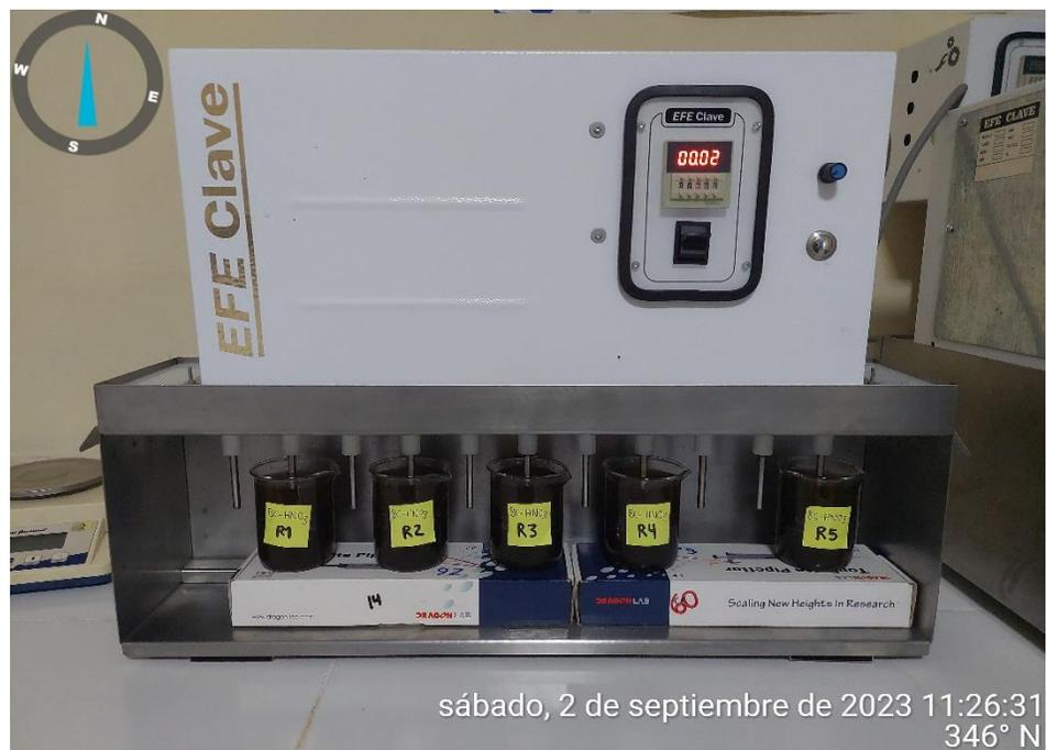
**Figura 70.** Agitación de la prueba 3.
