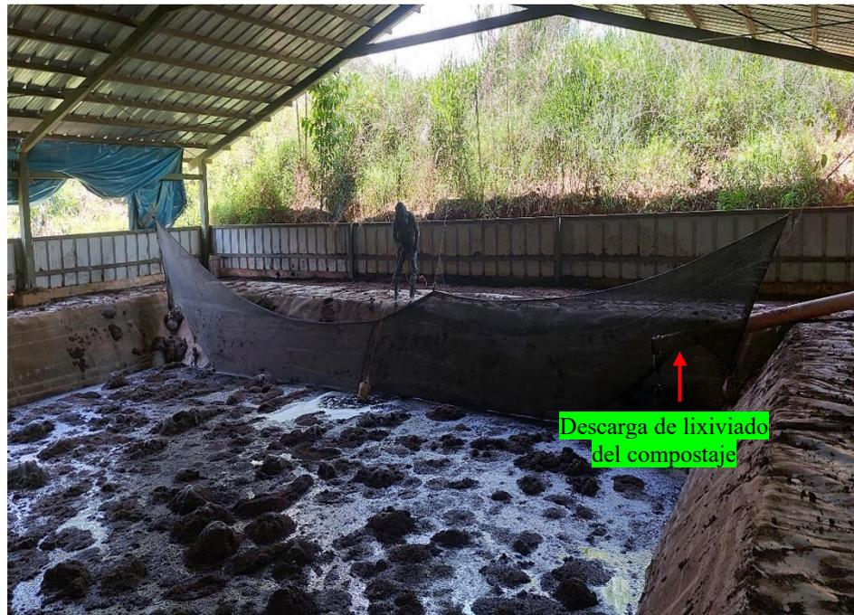
**Figura 53.** Última sección del pozo de lixiviados.
