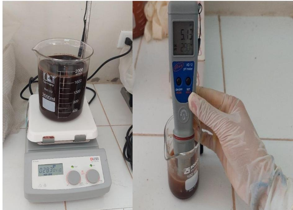
**Figura 45.** Agitación magnética para la impregnación del  $\text{HNO}_3$  en la BC.
