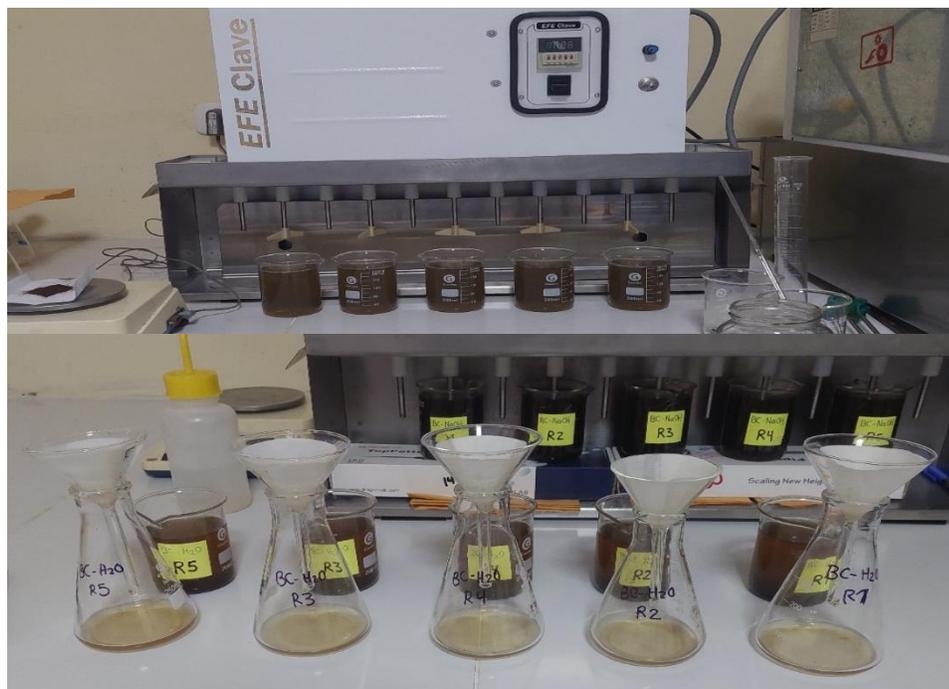
**Figura 68.** Agitación y filtrado de la prueba 1.
