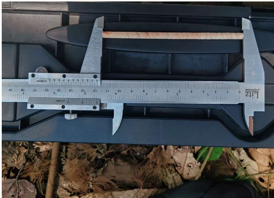
Figura 7. Medición de la longitud de una muestra (cilindro) con vernier mecánico
