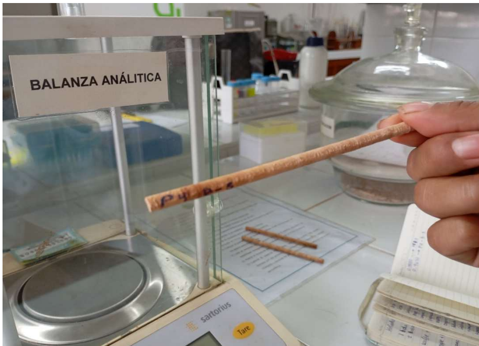
Figura 9. Pesaje de una muestra (cilindro) seca en estufa usando una balanza analítica
