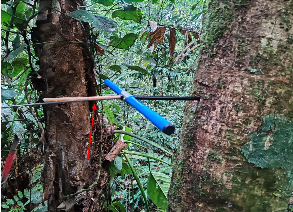
Figura 6. Extracción de la muestra (cilindro) de un árbol
