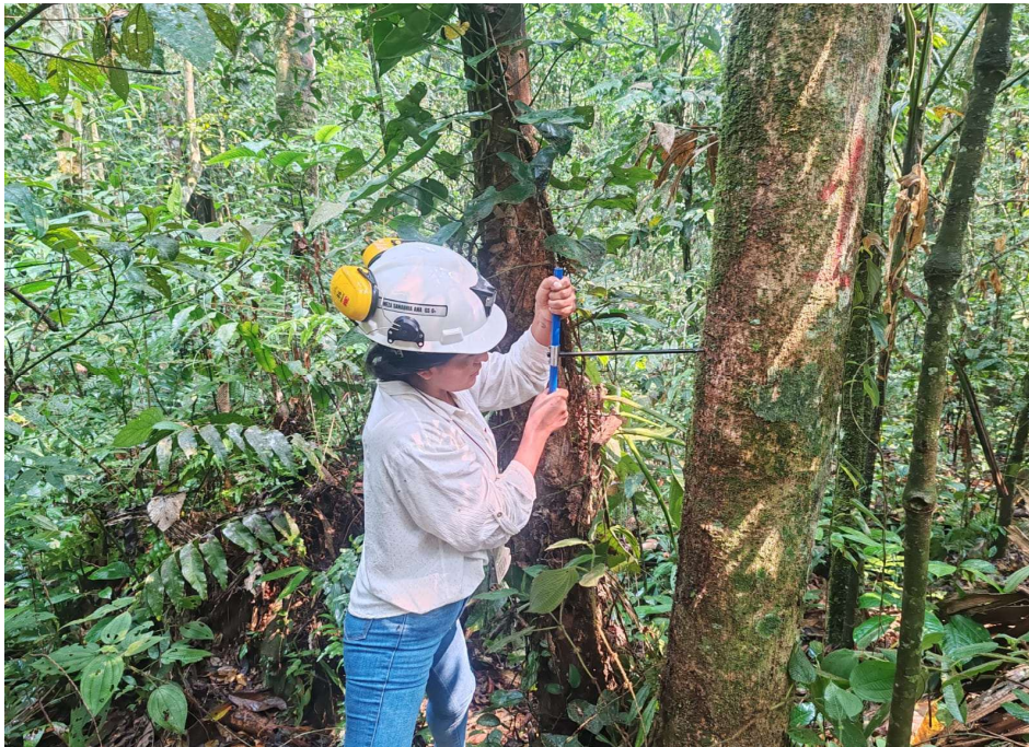
Figura 5. Barreno de Pressler insertado a 1,3m (DAP) en forma perpendicular al fuste
