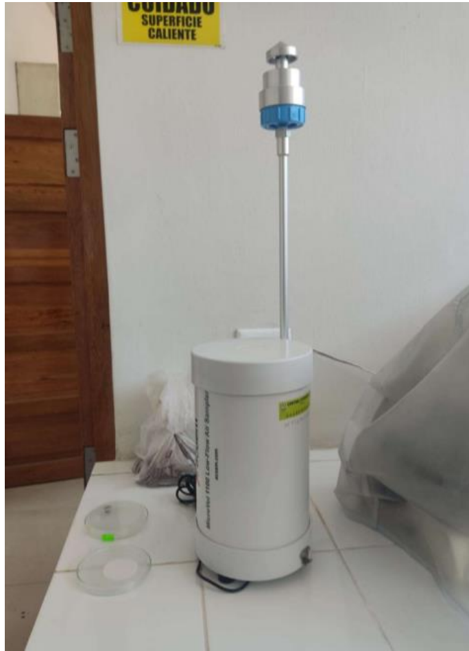
Figura 8. MicroVol-1100 muestreando en el Laboratorio de microbiología
