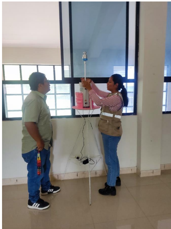
Figura 11. Instalación del MicroVol-1100 en la Hemeroteca
