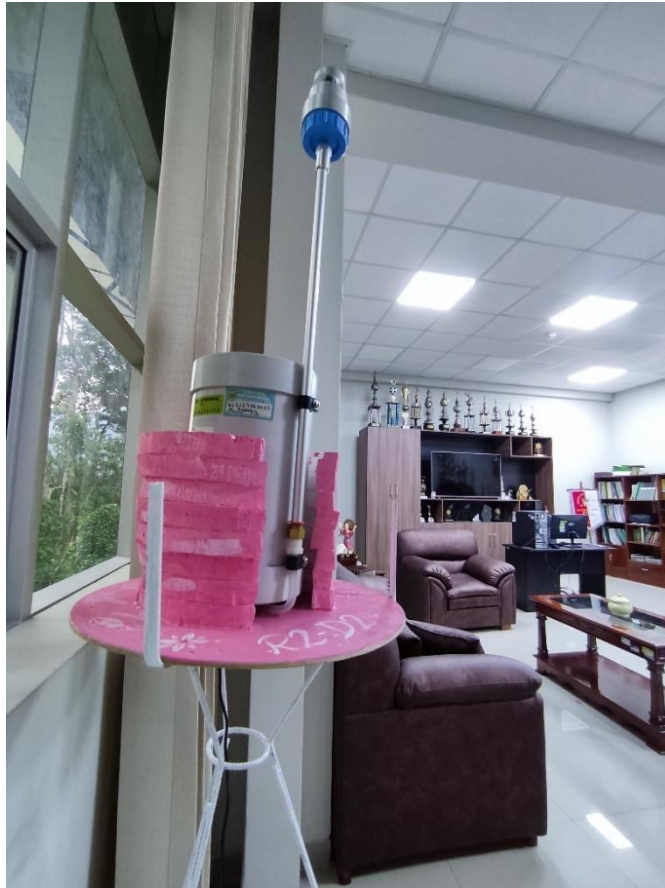
Figura 10. MicroVol-1100 muestreando en la Oficina de Rectorado
