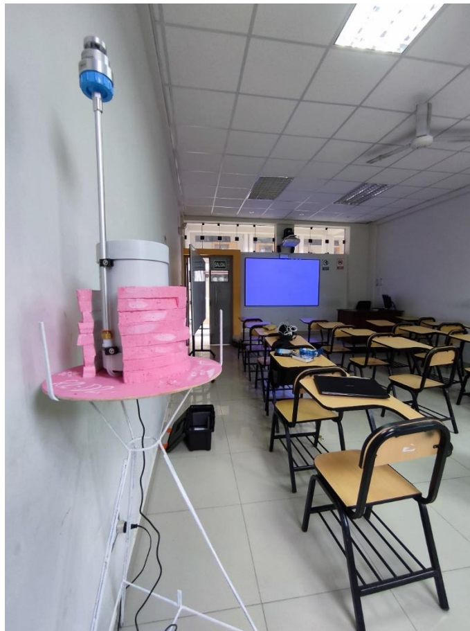
Figura 13. MicroVol-1100 muestreando en el Salón E-101
