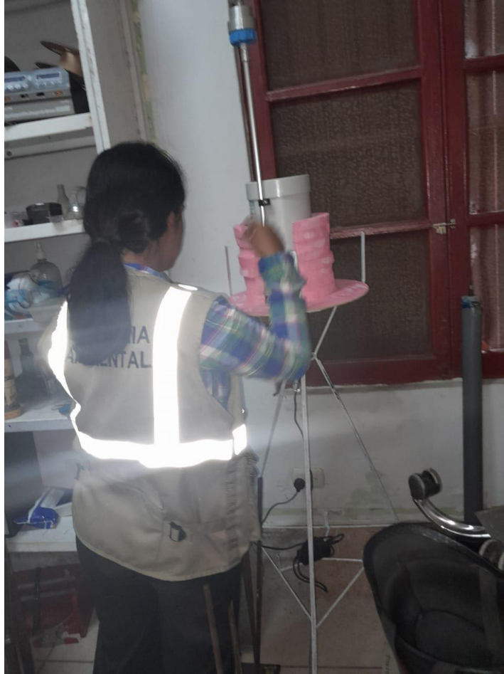
Figura 16. Instalación de MicroVol-1100 en la Unidad de Extensión – FIME
