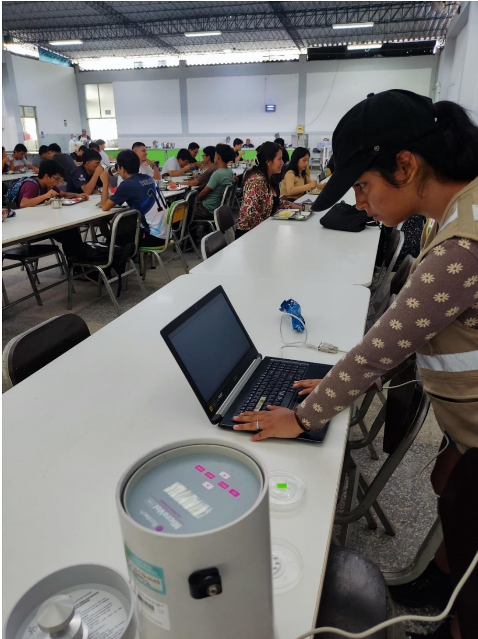
Figura 20. Transferencia de datos del MicroVol-1100 a computadora portátil
