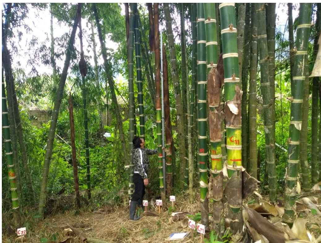
Figura 11. Medición de la altura con mira topográfica.
