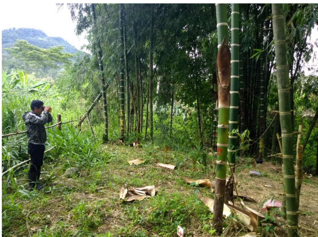
Figura 12. Estimación de la altura con Trupulse.
