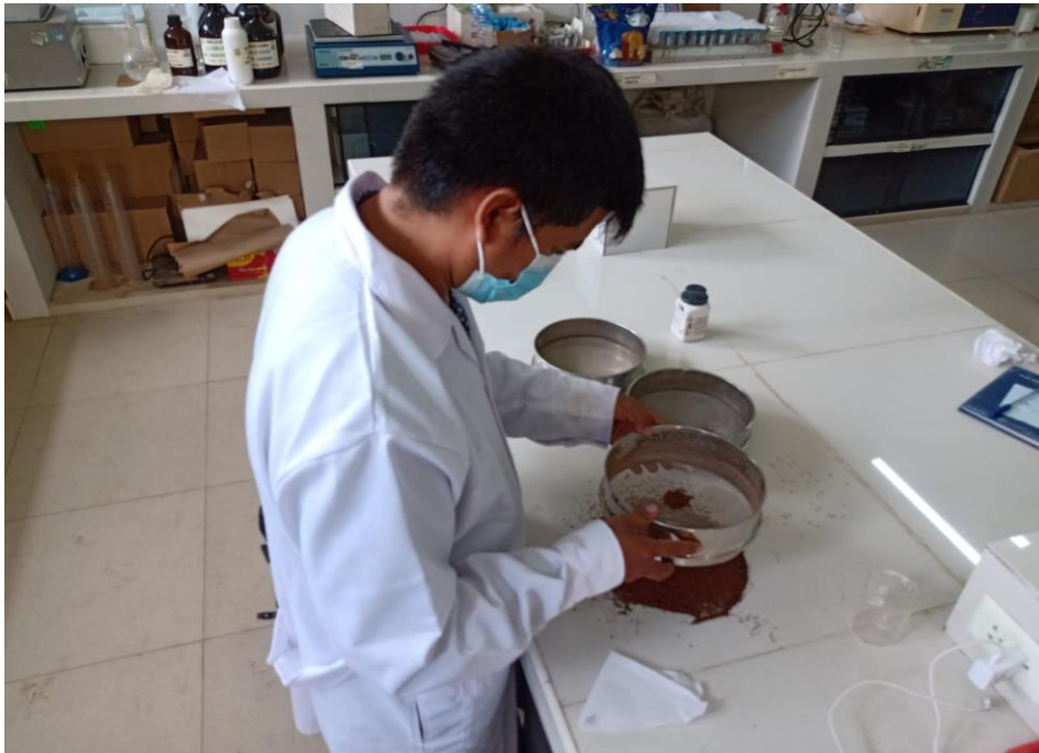
Figura 16. Tamizado de la cascarilla de la semilla de cacao
