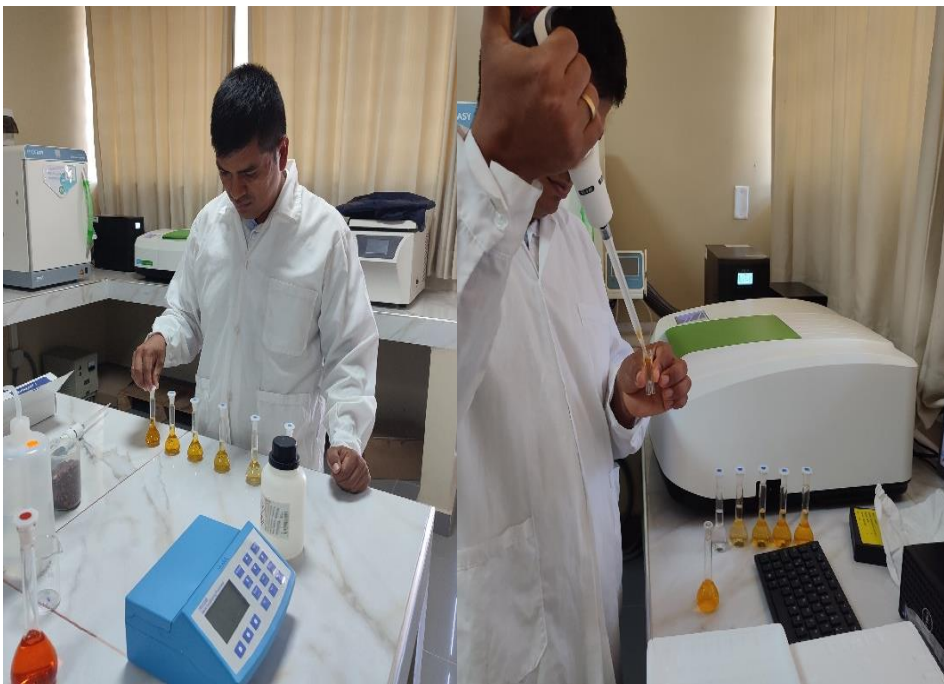
Figura 19. Preparación de soluciones de cadmio- ditizona para lectura de cadmio en el espectrofotómetro UV visible.
