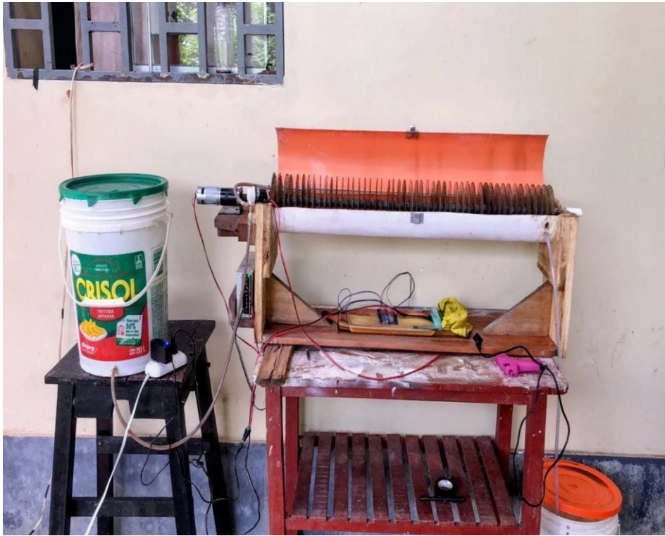
Figura 12. Funcionamiento del sistema de contactores biológicos a escala laboratorio.
