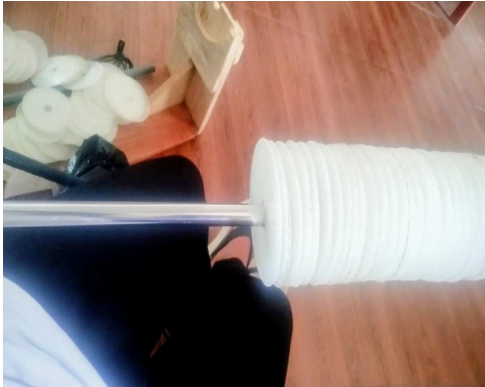
Figura 10. Configuración inicial del paquete de 44 discos sobre el eje horizontal rotatorio.
