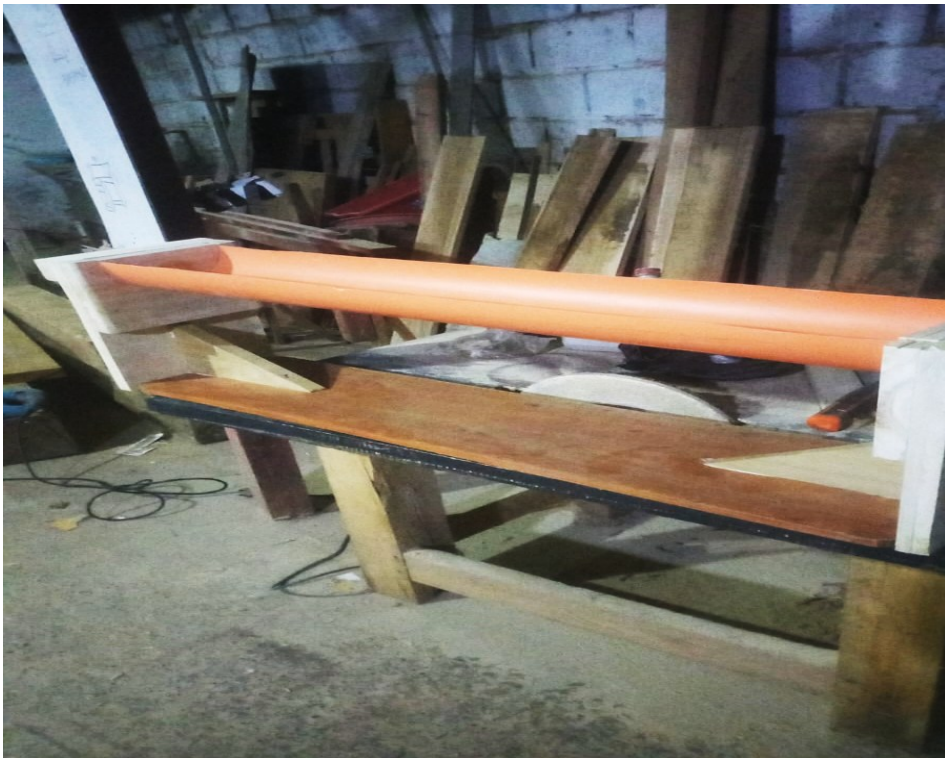
Figura 9. Construcción del sistema de contactores biológicos a escala laboratorio.
