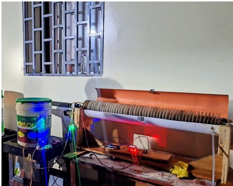
Figura 11. Acondicionamiento del sistema de contactores biológicos a escala laboratorio.
