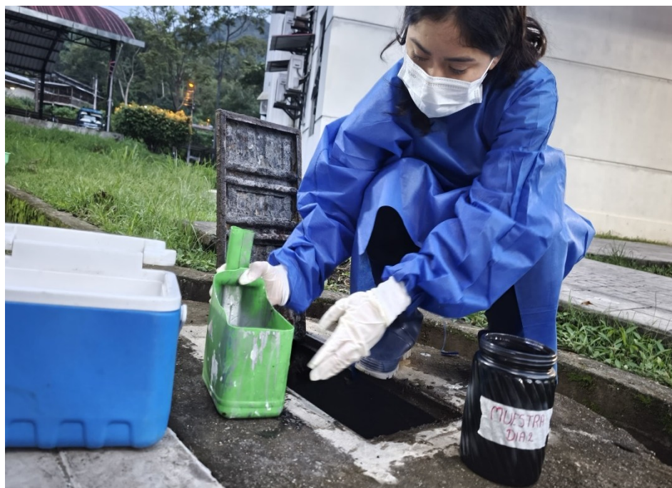
Figura 2. Recolección de muestra de agua residual en el buzón de desagüe del comedor universitario.
