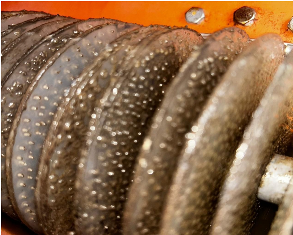
Figura 13. Desarrollo de biopelícula en contactor biológico rotatorio (RBC).
