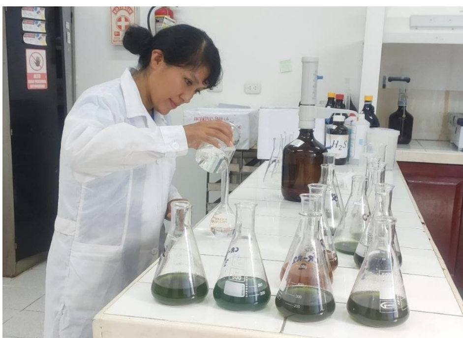
Figura 56. Determinación de la materia orgánica por el método de Walkley y Black.
