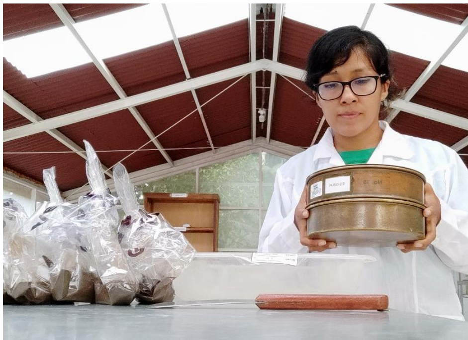
Figura 55. Tamizado de las muestras de suelo para determinar la materia orgánica.
